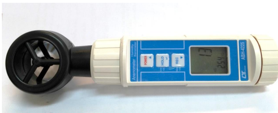
شکل ۵-۲۶: دستگاه اندازه‌گیری سرعت و دمای هوا (دستگاه ABH-4225).
