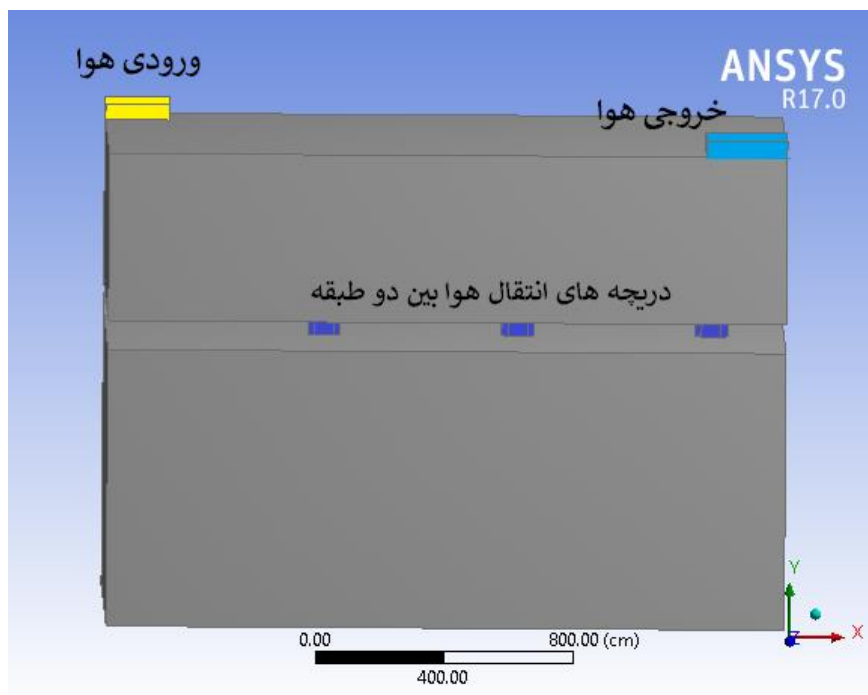
شکل ۴-۵: مدل هندسه اتاق برق و کنترل.
