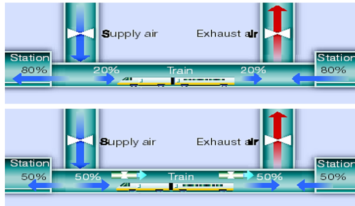
شکل ۲-۶: موقعیت شفت‌ها و تأثیر جت فن در تقسیم هوای ورودی از شفت [۱۰].
