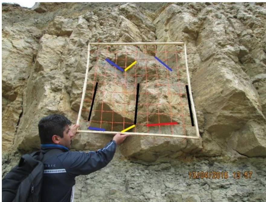
شکل ۴-۱۳ نمایی از برداشت پنجره‌ای به روش محاسبه P_{۳۱}
