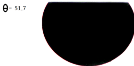
شکل ۵: مقدار زاویه تماس اندازه گیری شده در روز سوم آزمایش در نمونه نفتی گدون.
