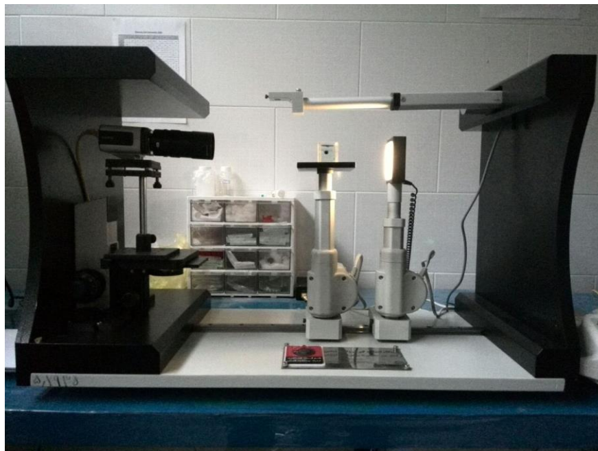
شکل ۳: دستگاه اندازه‌گیری زاویه تماس.
