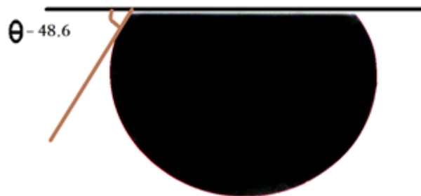
شکل ۴: مقدار زاویه تماس اندازه گیری شده در روز اول آزمایش در نمونه نفتی گدون.
