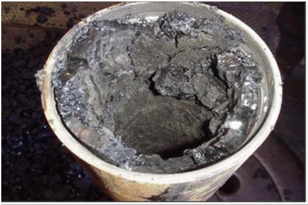
شکل ۱-۱: تشکیل رسوب در داخل لوله‌های نفتی (Mulins et al. , 2008).
