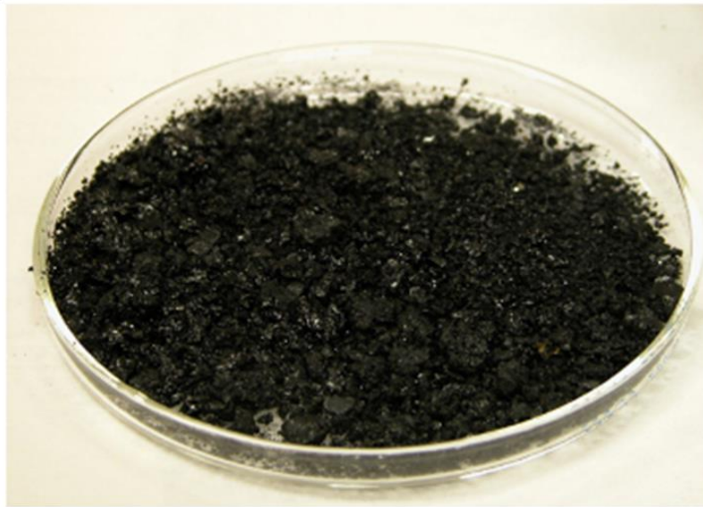
شکل ۲-۳: نمونه آسفالتین رسوب کرده در اثر اضافه شدن هپتان نرمال به نفت (Luo et al., 2010).
