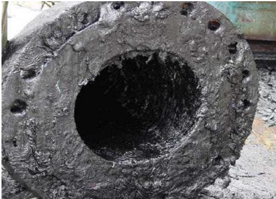
شکل ۱-۲: رسوب آسفالتین در تسهیلات سرچاهی (Thou et al. , 2002)
