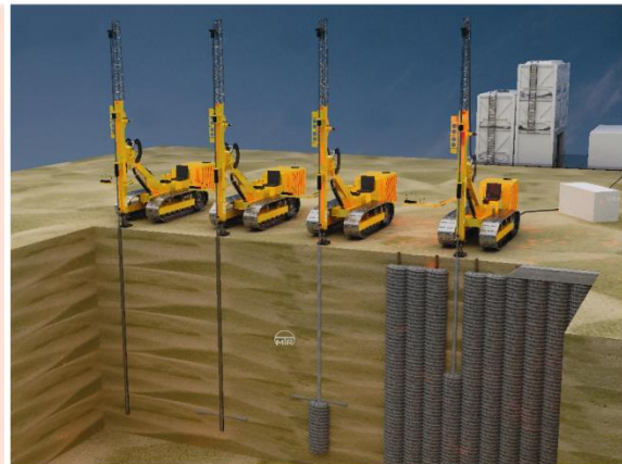
شکل ۲-۵: نمایی از روش تزریق با فشار زیاد (www.asconrouads.com)
