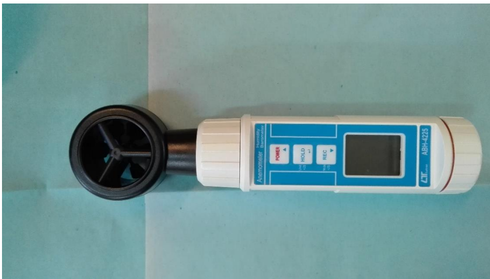
شکل (۲-۳) دستگاه ABH-4225 وسیله اندازه‌گیری سرعت و فشار هوا
