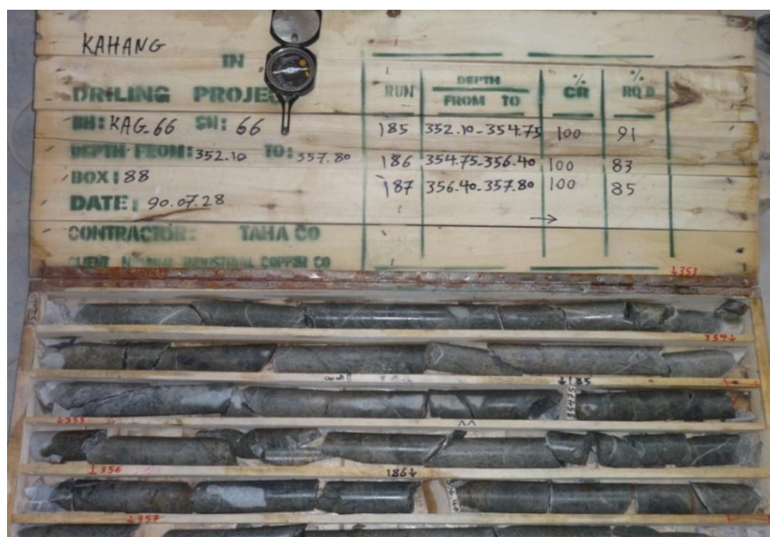
شکل ۴-۱۸: تصویر جعبه مغزه ۸۸ از گمانه ۶۶ بعد از برش مغزه
