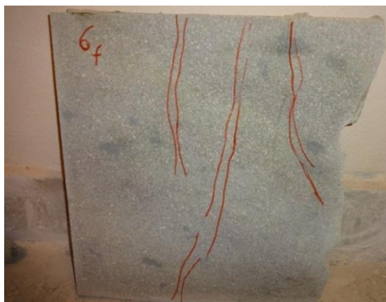
شکل ۴-۲۵: مشخص کردن سطوح ضعف روی سطح نمونه قبل از شکست
