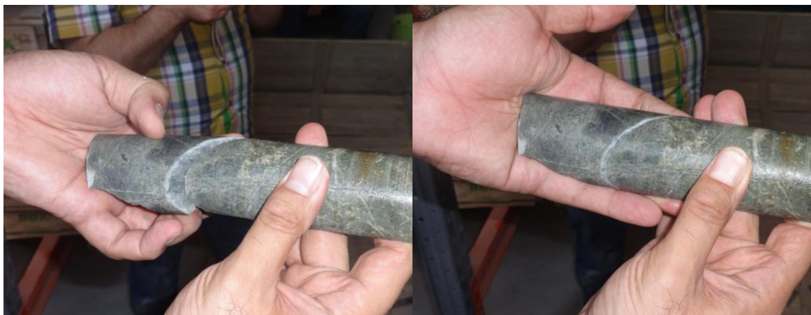
شکل ۴-۱۹: شکست ایجاد شده از روی سطح رگچه
