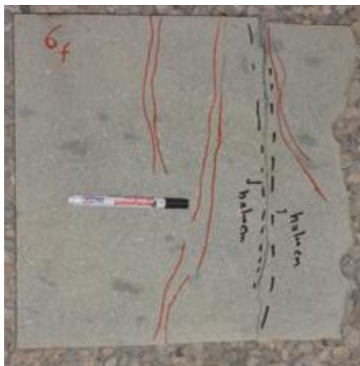
شکل ۴-۲۶: تعیین سطح شکست و مشخص نمودن ارتفاع رها سازی روی سطح شکست
