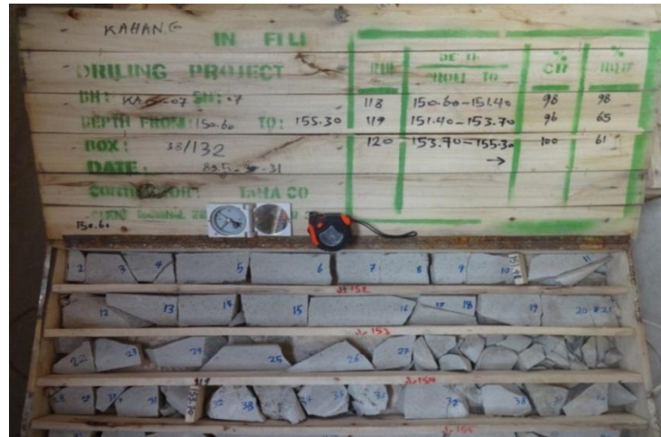
شکل ۴-۱۲: شماره‌گذاری ناپیوستگی‌ها (جعبه مغزه ۳۸ از گمانه ۷)
