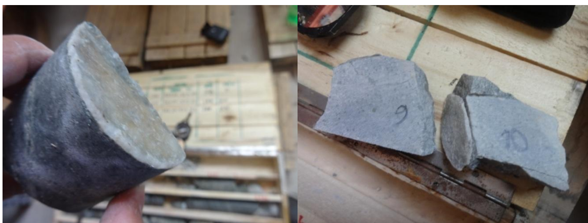
شکل ۴-۲۰: ضخامت رگچه پس از شکست نمونه از محل جوش خوردگی
