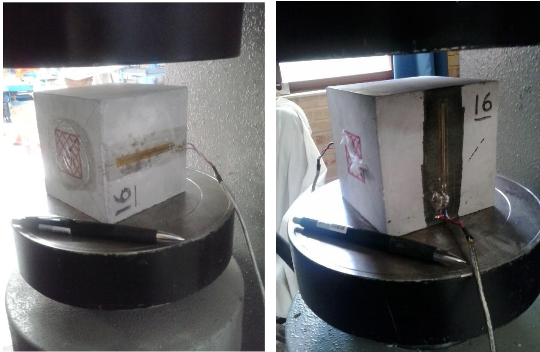
شکل ۳-۱۷ استفاده از ژل فراصوت در محل تراگذار
