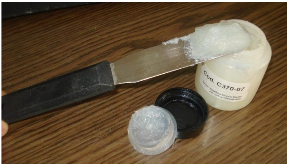
شکل ۳-۴ ژل فراصوت عامل جفت کننده بین تراگذار و نمونه
