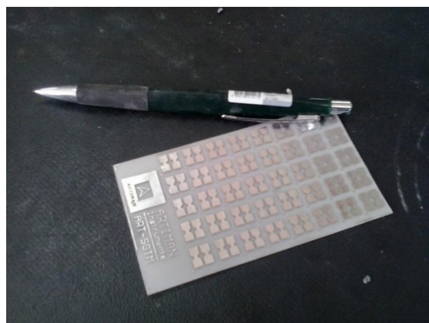
شکل ۳-۱۴ پایانه‌ی اتصال سیم کرنش سنج به مدار واسط
