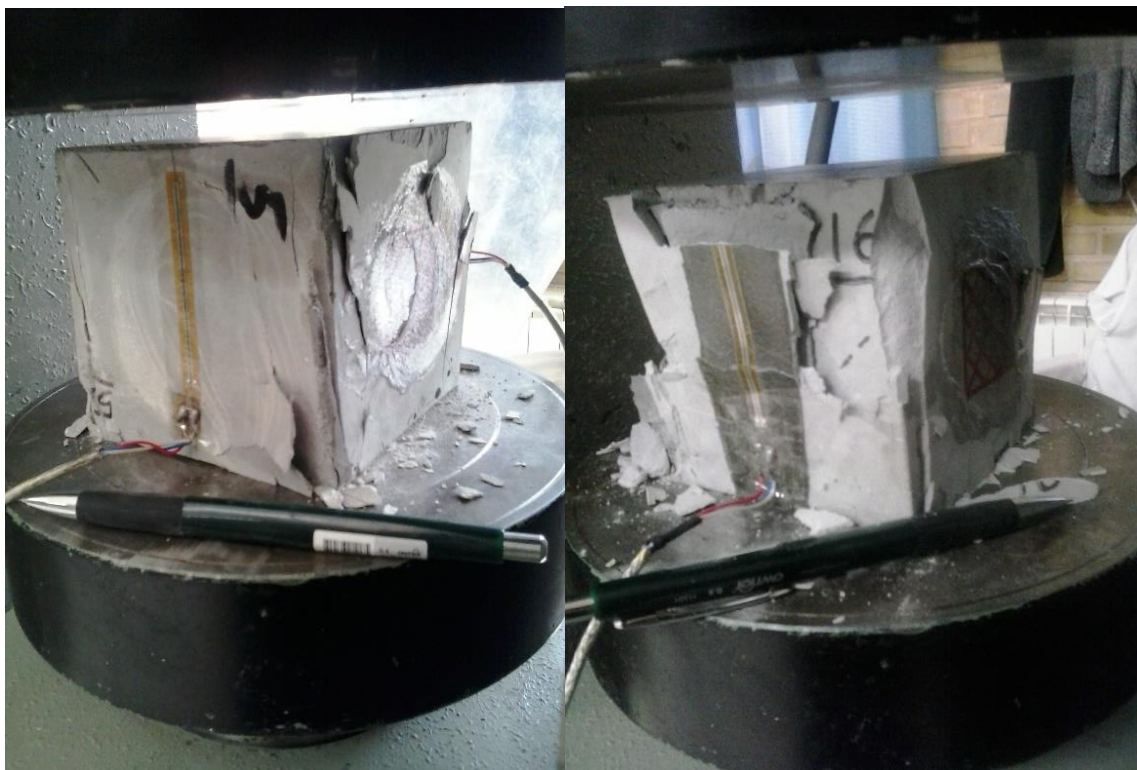
شکل ۱۸-۳ نمونه شکسته شده و پایان آزمایش
