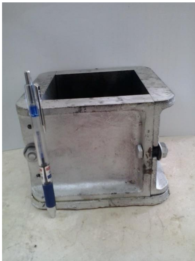
شکل ۳-۹ قالب تهیه نمونه‌های مکعبی ۱۰×۱۰×۱۰ سانتی متر مکعب
