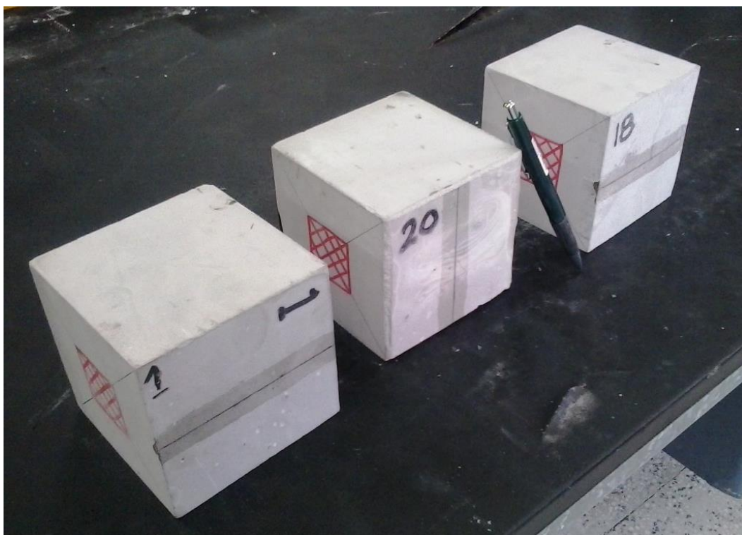
شکل ۳-۱۵ تعیین محل قرارگیری تراگذار
