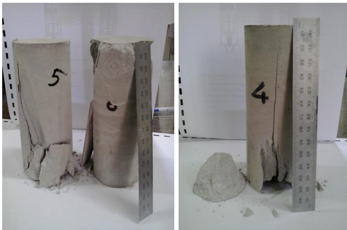
شکل ۳-۸ آزمایش مقاومت فشاری تک محوره بر روی نمونه های استوانه ای
