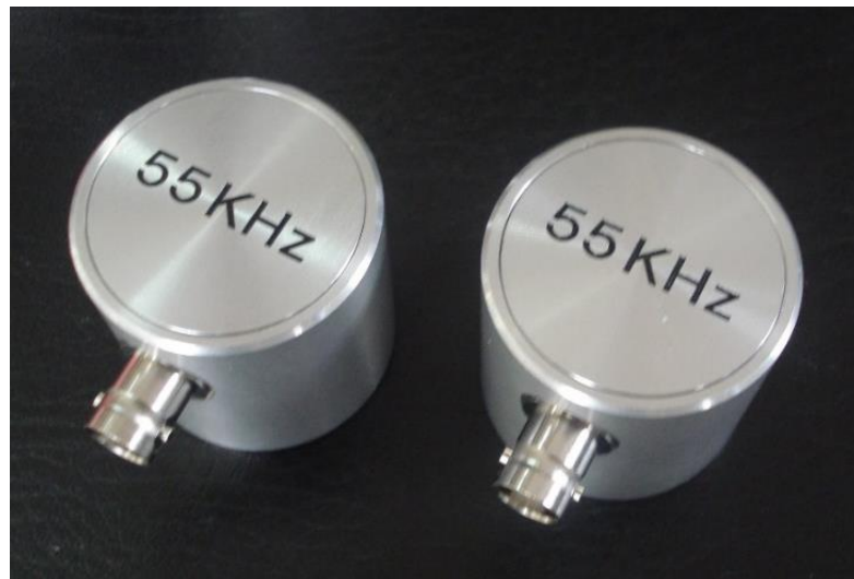
شکل ۳-۳ تراگذار عمودی ۵۵ کیلوهرتزی
