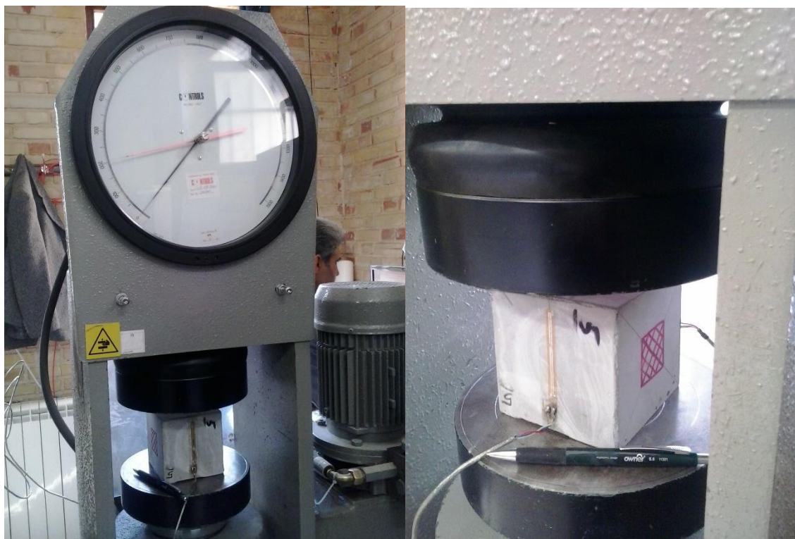
شکل ۳-۱۶ نمونه زیر دستگاه تست مقاومت فشاری تک‌محوره
