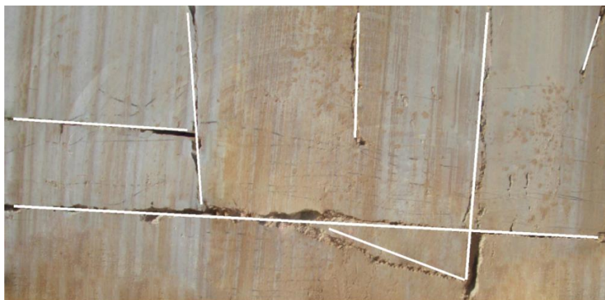
شکل (۴-۳۲) - نمایش خط اثرهای تشخیص داده شده بر روی تصویر اصلی
