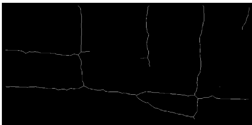
شکل (۴-۲۶) - تصویر حاصل از عملیات نازک‌سازی
