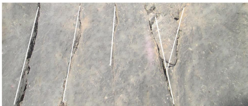
شکل (۴-۲۰) - نمایش خط اثرهای تشخیص داده شده بر روی تصویر اصلی
