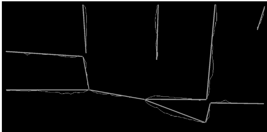
شکل (۴-۲۹) - تشخیص خط اثر ناپیوستگی‌ها و نمایش آن‌ها با خط
