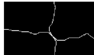
شکل (۴-۲۹) - تشخیص خط اثر ناپیوستگی‌ها و نمایش آن‌ها با خط
