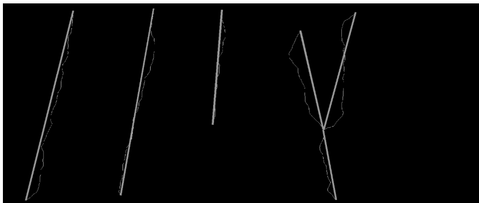
شکل (۴-۱۷) - تشخیص خط اثر ناپیوستگی‌ها و نمایش آن‌ها با خط
