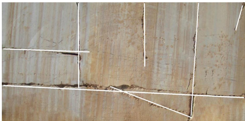
شکل (۴-۲۵) - نتایج نهایی حاصل از الگوریتم تبدیل هاف بر روی تصویر اصلی
