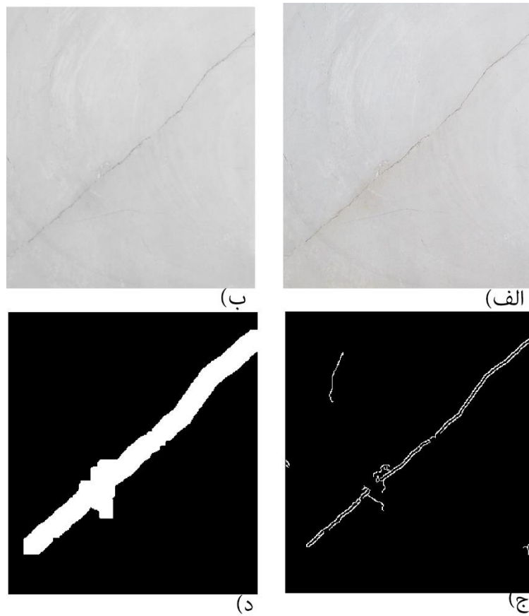
شکل (۷) - مراحل اولیه الگوریتم درجه همسایگی الف) تصویر اصلی، ب) تصویر حاصل از عملیات پیش پردازش، ج) تصویر حاصل از لبه‌یابی با آشکارساز کنی، د) تصویر حاصل از عملیات برجسب زدن اجزای متصل و عملیات گسترش
