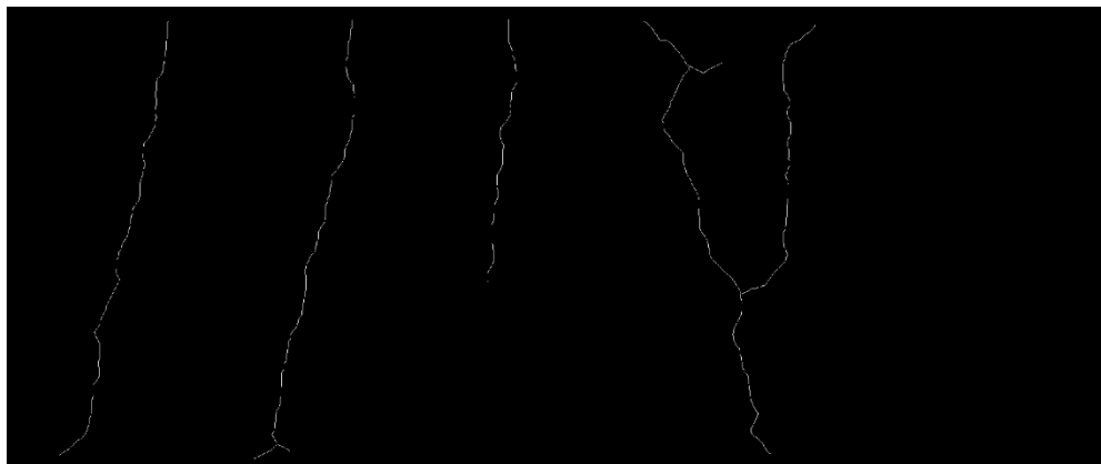
شکل (۱۳-۴) - تصویر حاصل از عملیات نازک‌سازی
