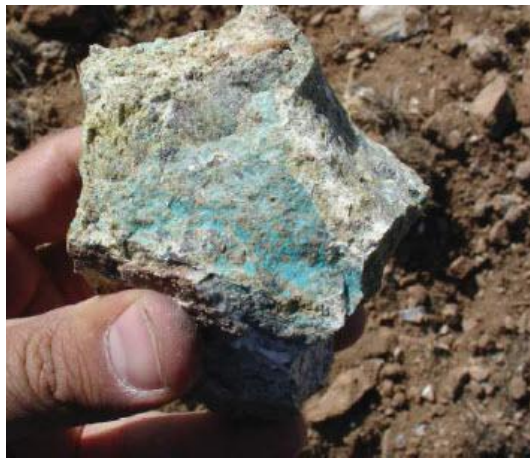
شکل (۲-۹): نمایی از کانه‌زایی مس به صورت مالاکیت در زون اکسیدی کانسار عشوند [سازمان زمین‌شناسی کشور، ۱۳۹۰]
