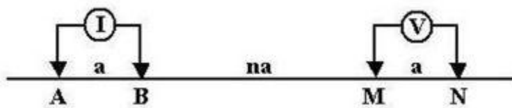
شکل (۴-۴): آرایش دوقطبی - دوقطبی [Loke, 2004].
