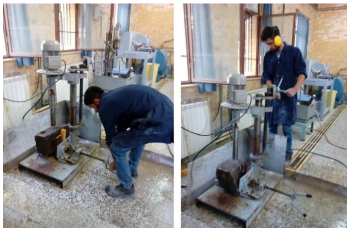
شکل ۴-۶ فرآیند گرفتن مغزه از بلوک‌های سنگی.
