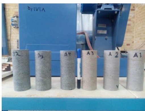
شکل ۴-۸ مغزه‌های آماده‌سازی شده بر اساس استاندارد ISRM.
