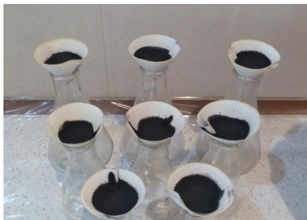
شکل (۳-۴): نمایی از انجام آزمایش‌های مربوط به تعیین نرخ انحلال پیریت و عملیات فیلتر کردن
