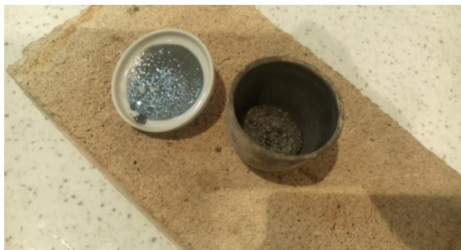
شکل (۳-۲): نمایی از مواد باقیمانده پس از حرارت‌دهی در روش اندازه‌گیری مواد فرار
