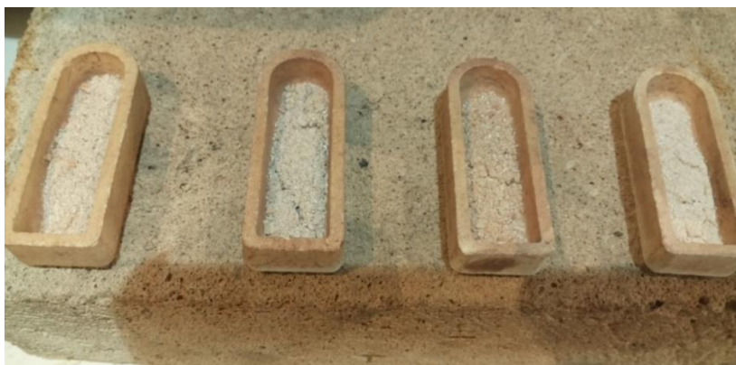
شکل (۱-۳): نمایی از چند نمونه خاکستر اندازه‌گیری شده در آزمایشگاه
