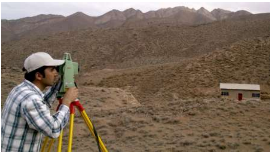
شکل ۴-۹: برداشت داده‌های توپوگرافی و مختصات ایستگاه‌های اندازه‌گیری
