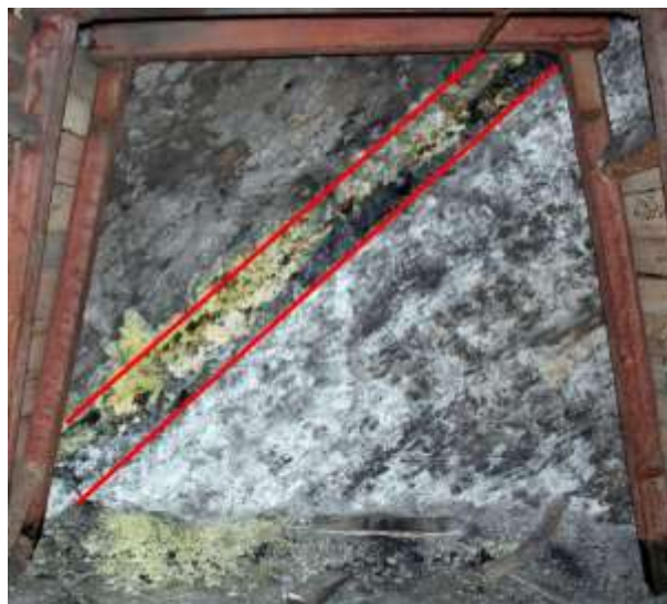
شکل ۴-۶: نمایی از رگه زغال سنگ در انتهای تونل دنباله لایه
