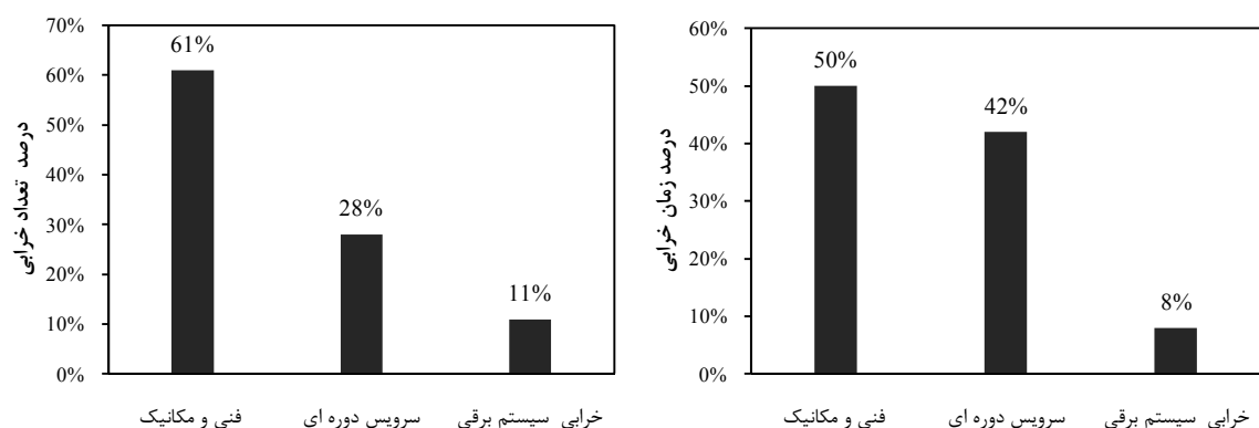
شکل ۴-۹ نمودار پارتو خرابی نوار نقاله شماره ۱
