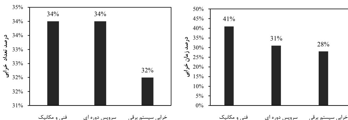
شکل ۴-۱۹- نمودار پارتو خرابی لکوموتیو شماره ۴
