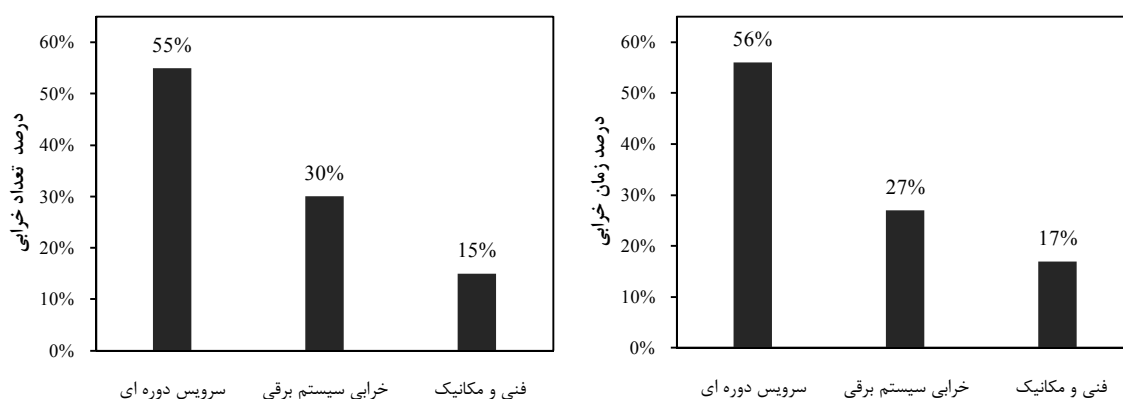
شکل ۴-۳۷ نمودار پارتو خرابی لکوموتیو شماره ۵
