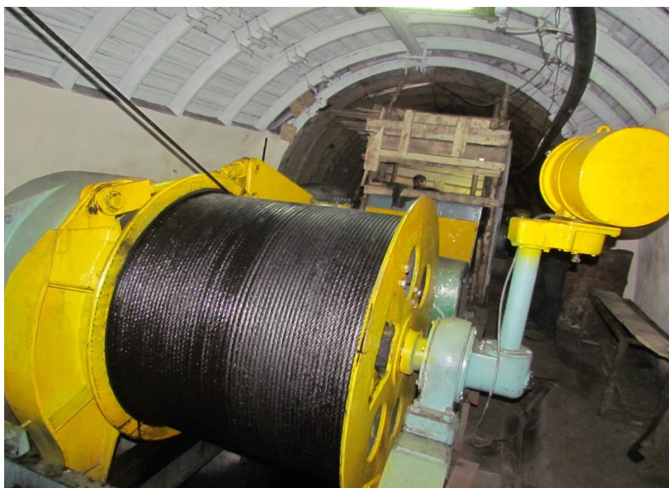
شکل ۳-۵- دستگاه وینچ ۱۶۰۰ معدن بزرگ
