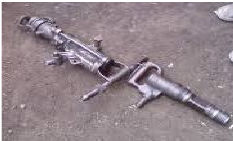
شکل ۳-۴- نمونه ای از پیکور مدل A7 و پرفراتور ۱۴ کیلویی در معدن بزرگ طزره
