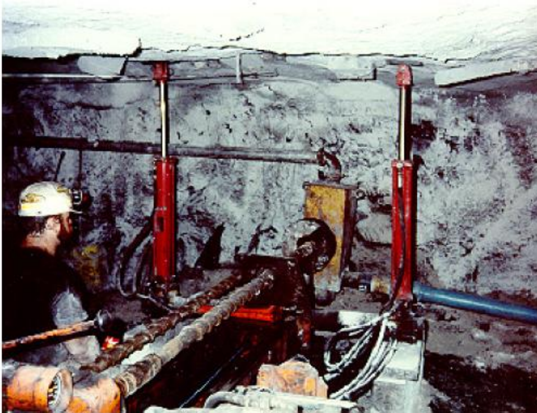
شکل ۳-۱۴: شمایی از زهکشی متان در یک معدن با استفاده از گمانه های افقی
