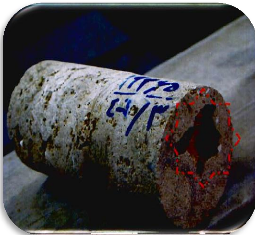
سنگ آهک مرجانی (عمق ۴-۶ متری گمانه ۳)
