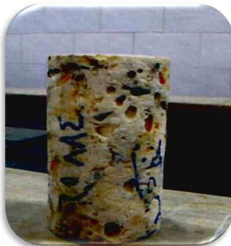
سنگ آهک مرجانی (عمق ۲-۴ متری گمانه ۷)
