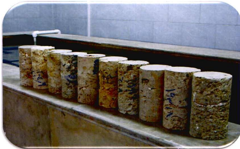
الف: سنگ آهک مرجانی به همراه ماسه سخت شده
