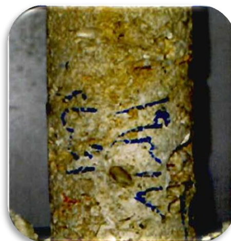
سنگ مارن (عمق ۶-۸ متری گمانه ۸)
