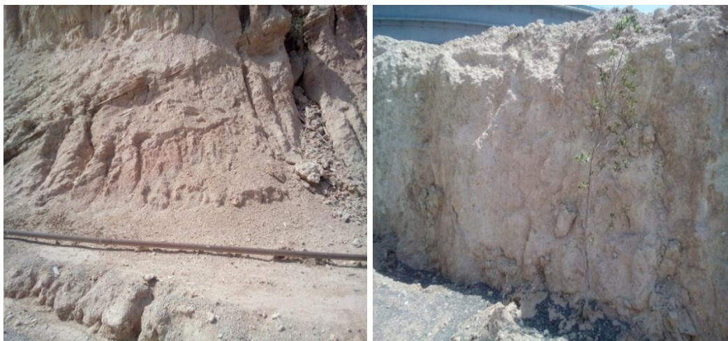
شکل ۴-۴- وضعیت ناپیوستگی ها و توالی لایه ها در محوطه مخازن خارک
