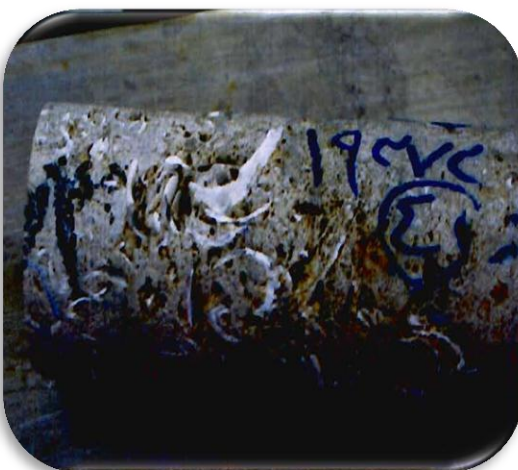
سنگ آهک مرجانی (عمق ۰-۲ متری گمانه ۴)
