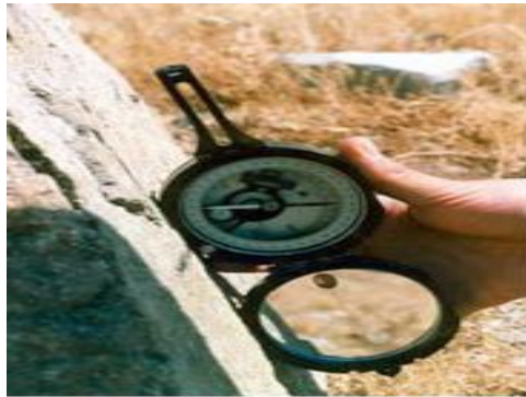
شکل ۳-۶- نحوه قرار گرفتن کمپاس، برای برداشت شیب
