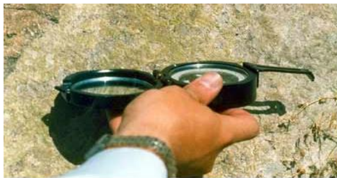
شکل ۳-۷- نحوه قرار گرفتن کمپاس برای تعیین جهت شیب
