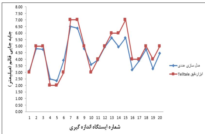
شکل ۴-۵۲- نمودار مقایسه جابه‌جایی قائم قرائت شده ابزار دقیق در معدن طبس و نتایج مدل‌سازی عددی
