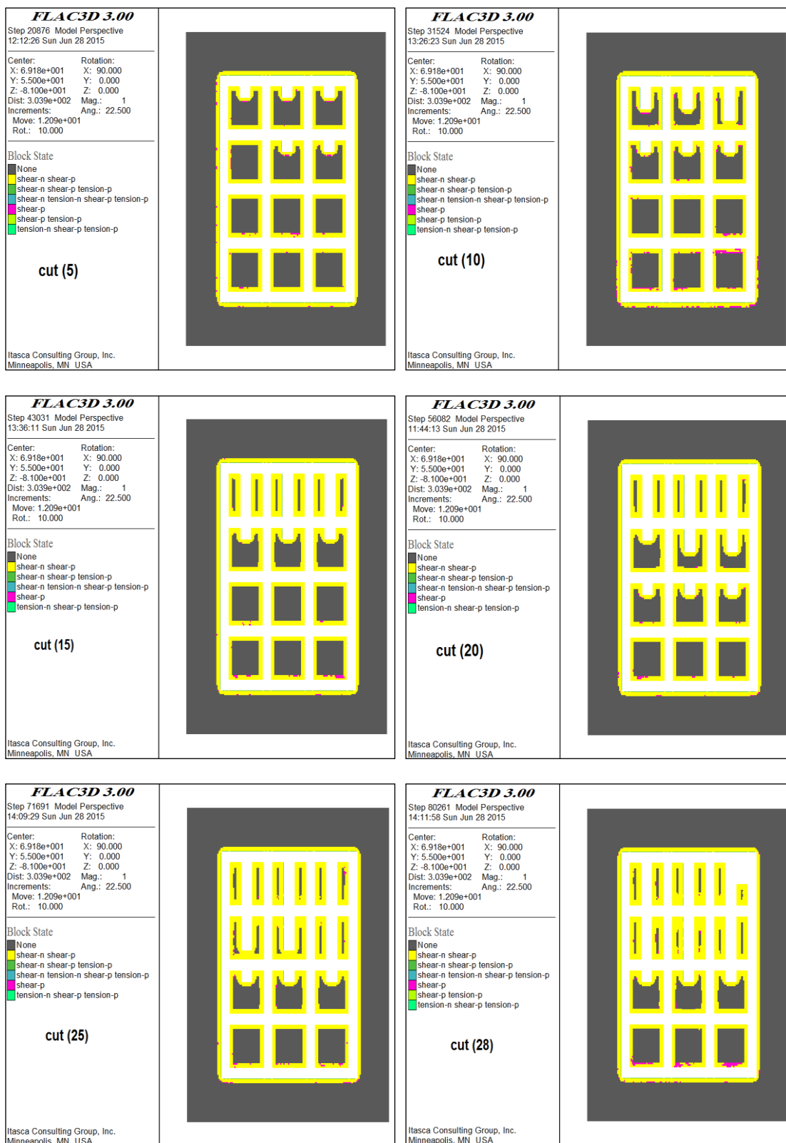
شکل ۴-۲۵- پلات‌های جریان پلاستیک برش‌های شماره ۵، ۱۰، ۱۵، ۲۰، ۲۵ و ۲۸ روش شکاف و حفاظ اصلاح شده
