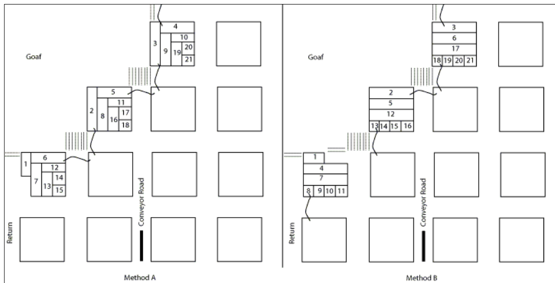
شکل ۲-۱۰ دو نمونه از بازیابی پایه ها با استفاده از روش ته باز (www.uow.edu.au)
