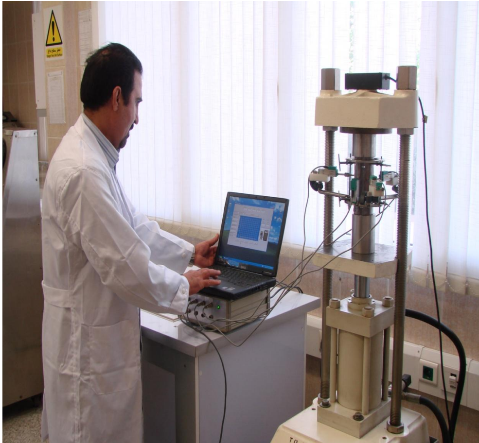
شکل ۹-۴- دستگاه اندازه‌گیری مدول یانگ و نسبت پواسون
