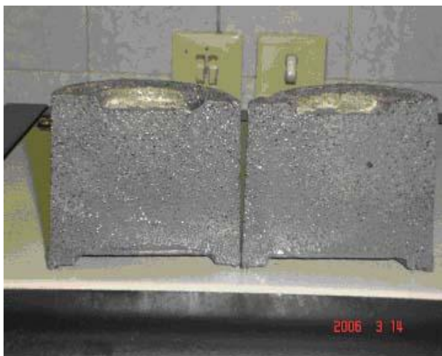
شکل ۶-۳۶- چگونگی توزیع افزودنی الاستیک‌کننده در سیمان حاوی ۱۲ درصد وزنی الاستومر
