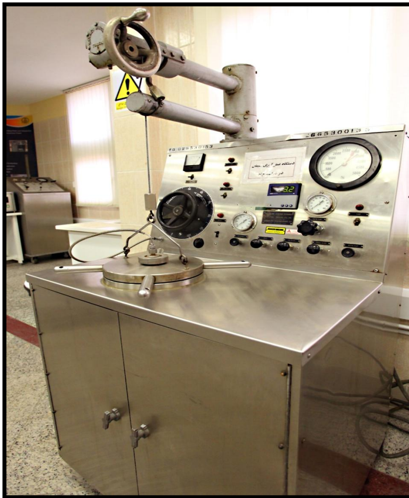
شکل ۴-۲- دستگاه عمل‌آوری دوغاب سیمان در شرایط دما و فشار بالا
