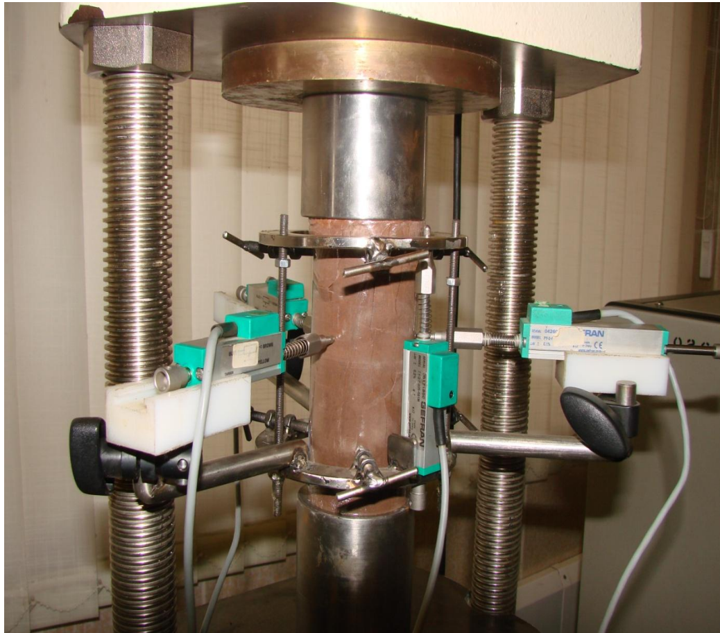
شکل ۴-۸- سنسورهای جابجایی برای محاسبه نسبت بواسون
