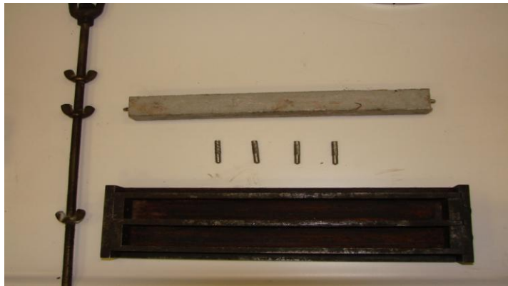
شکل ۴-۴- قالب‌های مستطیلی شکل انبساط سیمان
