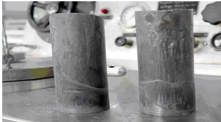
شکل ۶-۷- نمونه‌های استوانه‌ای تهیه شده از سنگ سیمان چاه مارون ۱۷۹
