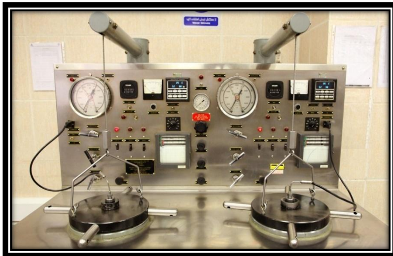
شکل ۵-۱- دستگاه نیم‌بندش با قابلیت اعمال دما و فشار
