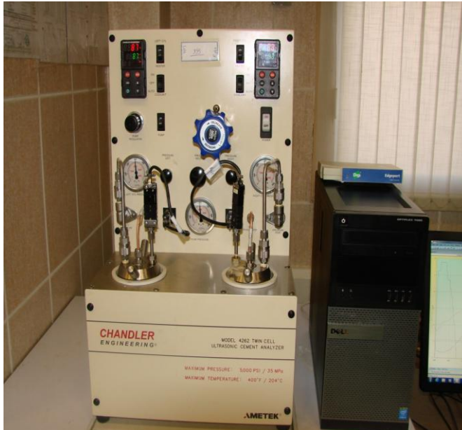
شکل ۴-۵- دستگاه اندازه‌گیری مقاومت فشاری با استفاده از امواج صوت (UCA)
