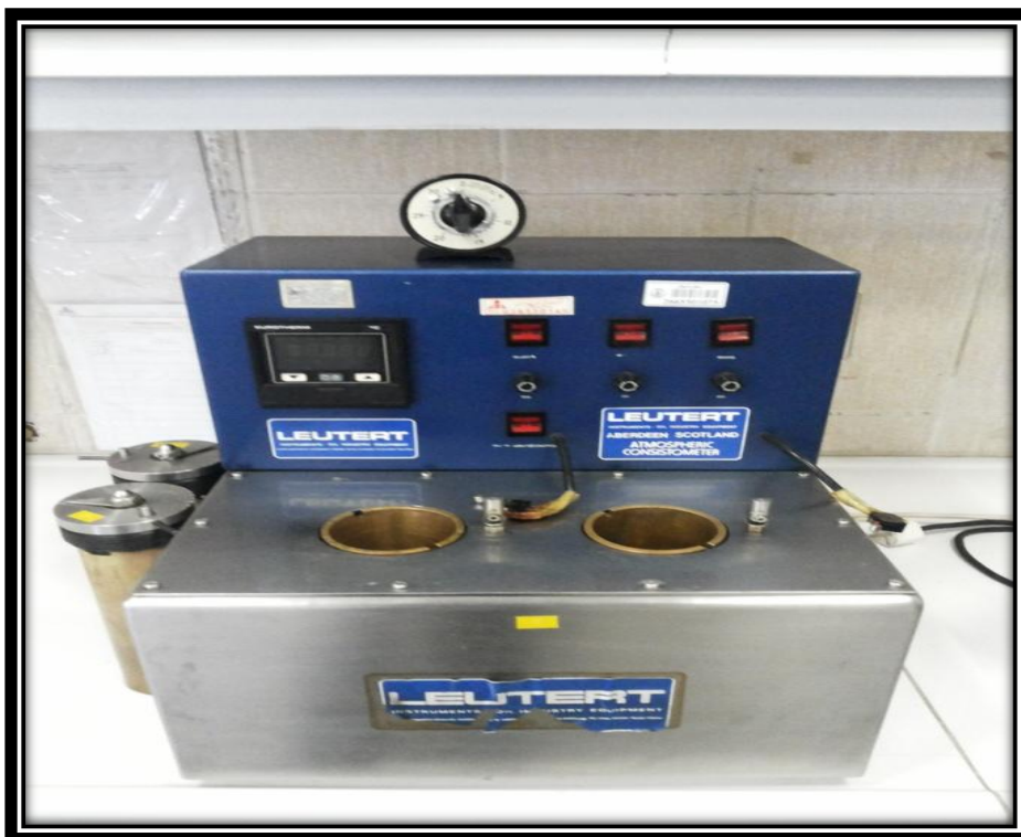
شکل ۳-۵-۲- نمایش از دستگاه کانسیستومتر اتمسفریک
