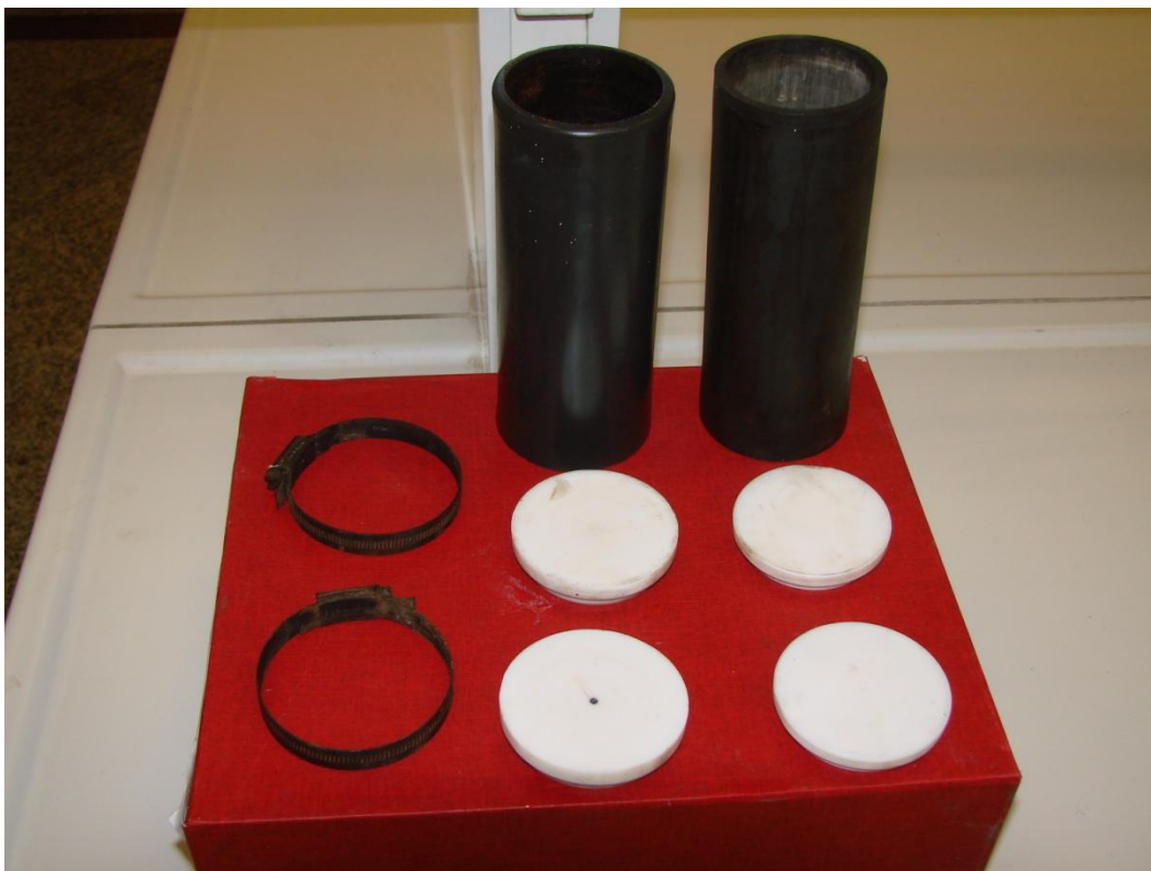
شکل ۴-۱- قالب‌های استوانه‌ای لاستیکی دما و فشار بالا با متعلقات آن
