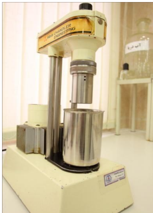
شکل ۵-۷- گرانروی سنج دوار فن ۳۵
