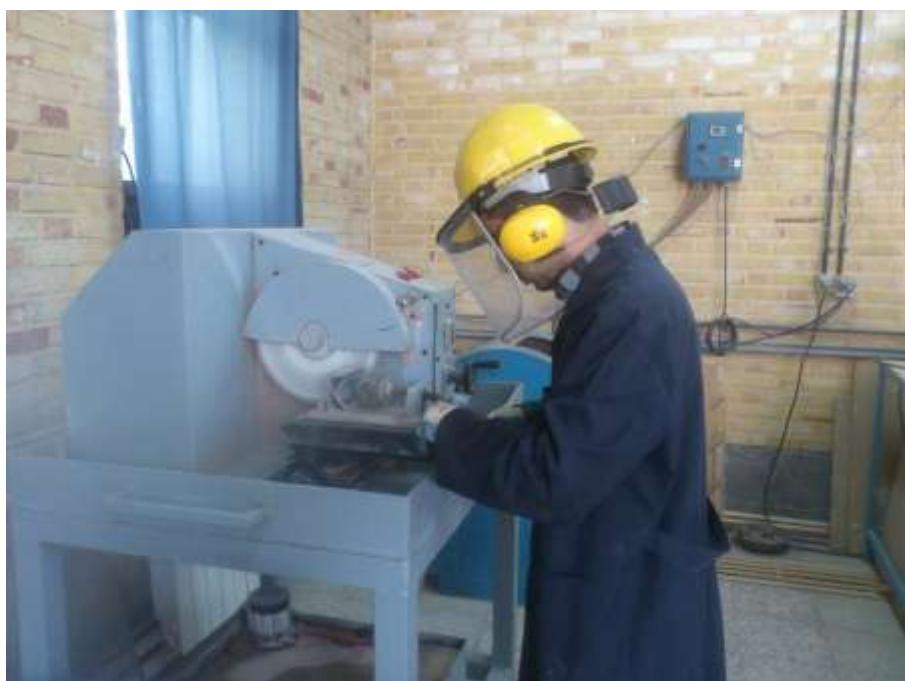
شکل (۲۲-۶): آماده‌سازی نمونه در آزمایشگاه برای تعیین چقرمگی شکست
