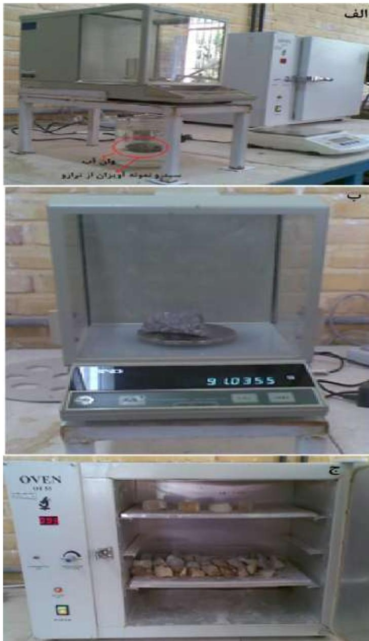
شکل (۱۹-۶): (الف) اندازه‌گیری جرم اشباع غوطه و (ب) اندازه‌گیری جرم اشباع با سطح خشک شده (ج)
