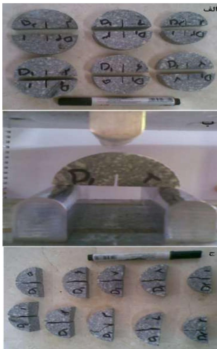
شکل (۲۳-۶): نمونه‌های آزمایشگاهی برای تعیین چقرمگی شکست حالت I (الف) قبل از بارگذاری (ب) حین بارگذاری (ج) بعد از بارگذاری
