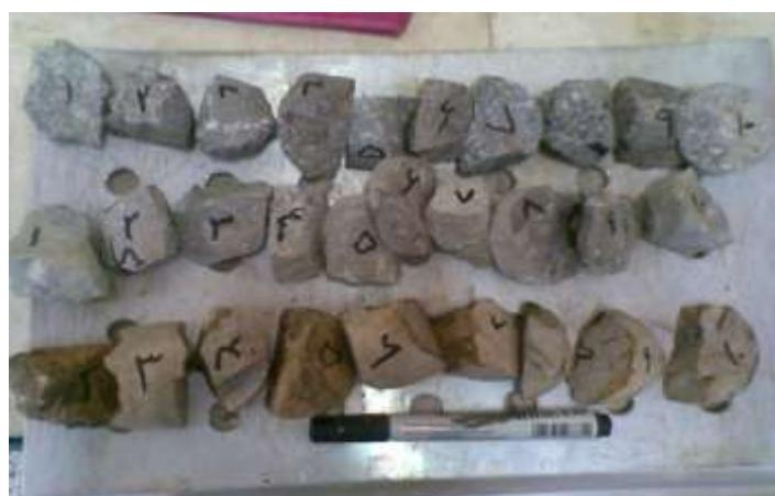
شکل (۶-۱۸): نمونه های تهیه شده برای تعیین چگالی خشک و تخلخل
