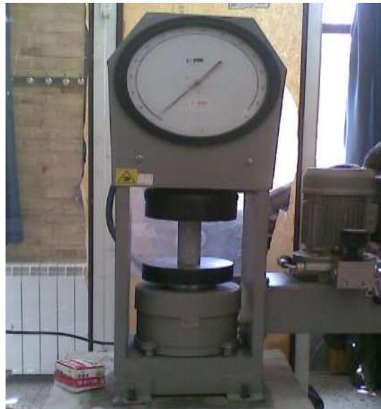
شکل (۲۱-۶): نمونه دستگاه آزمایش مقاومت فشاری تک محوری
