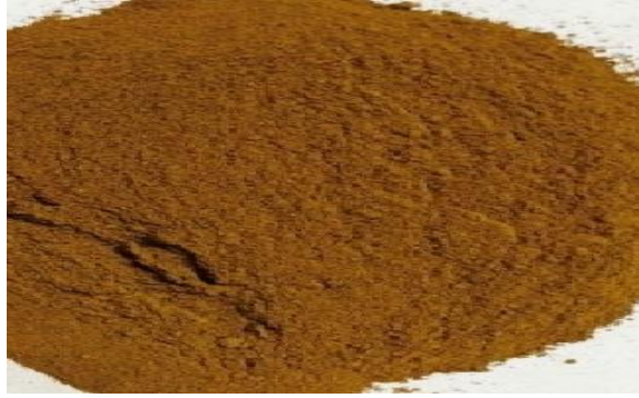
شکل ۳-۱: نمونه با ابعاد >75 میکرومتر، قبل از ورود به آسیای ماهواره ای
