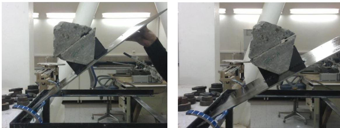
شکل ۴-۱۷- آزمایش میز شیب‌دار بر روی قطعات بتنی قبل از لغزش (راست) و در حین لغزش (چپ)
