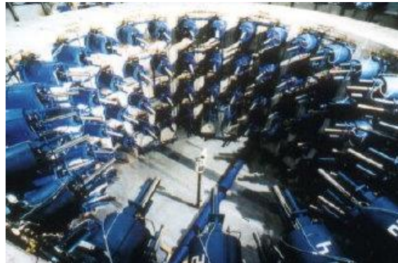
شکل (۲-۱۲) جزئیات آزمایش مقیاس کامل پوشش چهارمین تونل Elbe (Schreyer & Winselmann, 2000)
