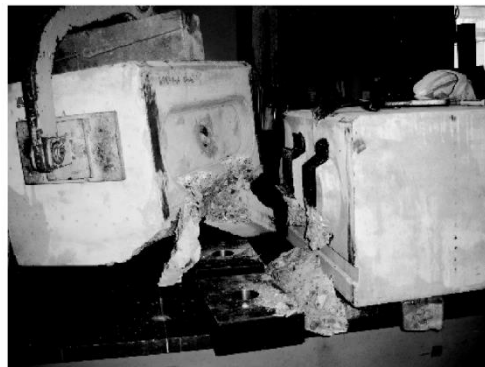
شکل (۱۸-۲) نتیجه آزمایش برش بر روی درزه‌های با اتصال کام و زبانه در تنش نرمال ثابت (Mayer, et al., 2007)
