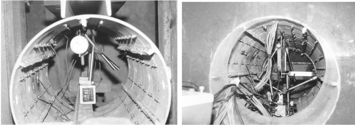
شکل (۲-۱۶) مدل آزمایشگاهی پوشش سگمنتال تحت شرایط بارگذاری مختلف؛ (مدل چپ) نقطه‌ای و (مدل راست) مدفون در خاک متراکم (Tang, 1988)
