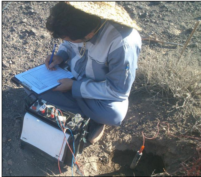
شکل ۳-۸- برداشت داده‌های مقاومت‌ویژه و قطبش‌القایی با استفاده از دستگاه Terrameter SAS4000
