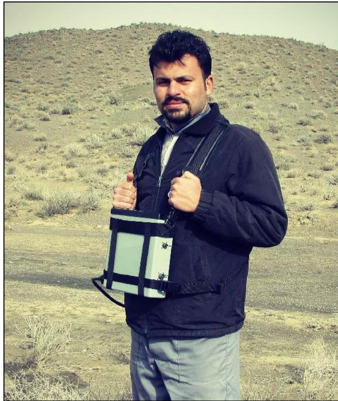
شکل ۳-۱۰- برداشت داده‌های VLF با استفاده دستگاه GEM GSM- 19T
