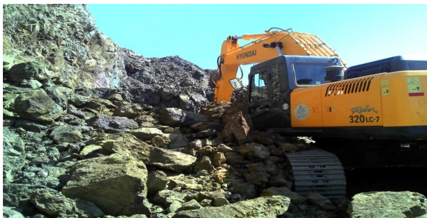
شکل ۱-۱: ریزش دیواره بر روی بیل مکانیکی در حین انجام عملیات استخراج در کنار دیواره
