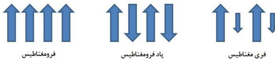
شکل ۲-۳: صفبندی حوزه‌های مغناطیسی در انواع مواد فرومغناطیسی
