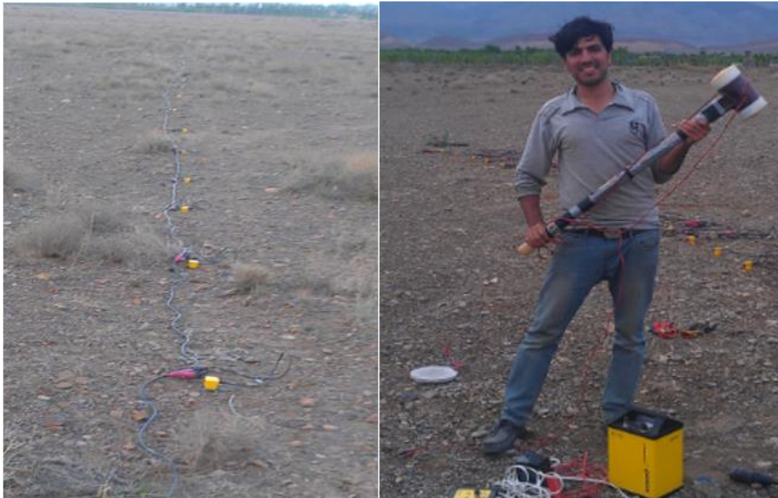
شکل ۴-۴: نمای پروفیل‌های برداشتی و همچنین صفحه فلزی ( 20 \times 20 \text{ cm}^2 ) و پتک (10kg) برای تولید موج فشاری P
