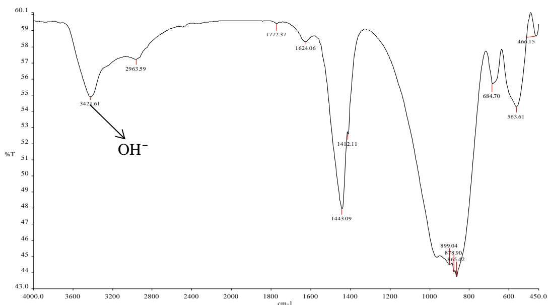
شکل (۳-۶): طیف FT-IR جاذب نانودیاتومیت مغناطیسی در زمان ۱ دقیقه.
