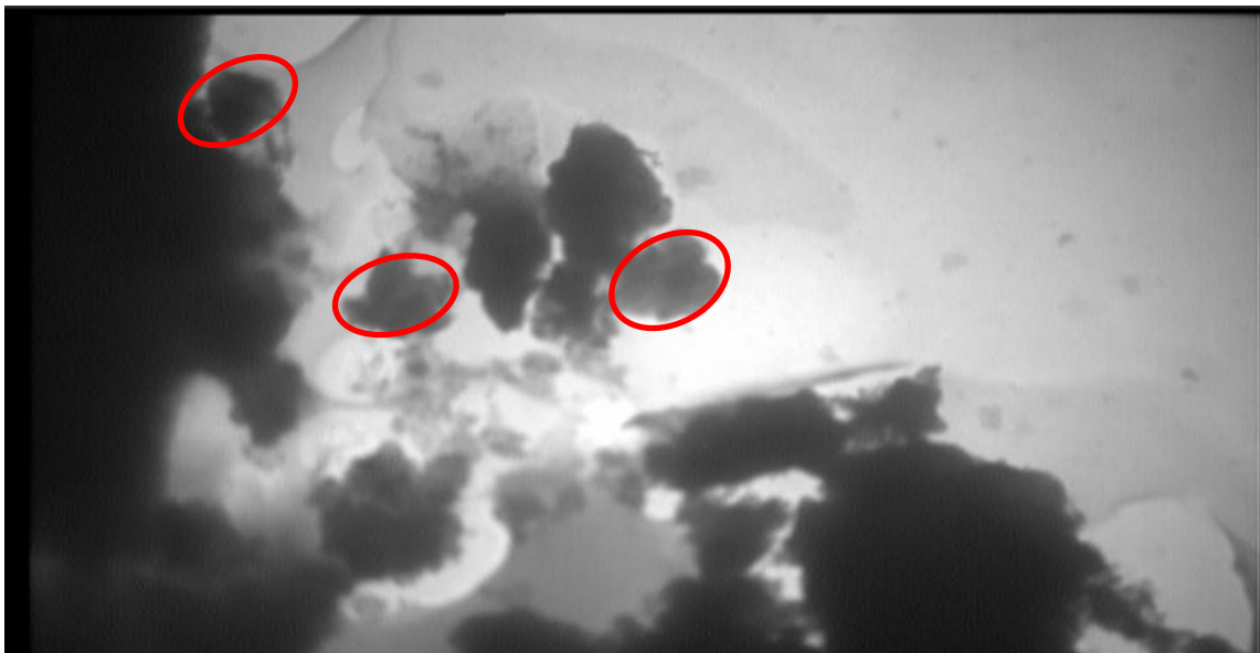
شکل (۳-۳): تصویر TEM نانودیاتومیت مغناطیسی ۱۰۰ nm
