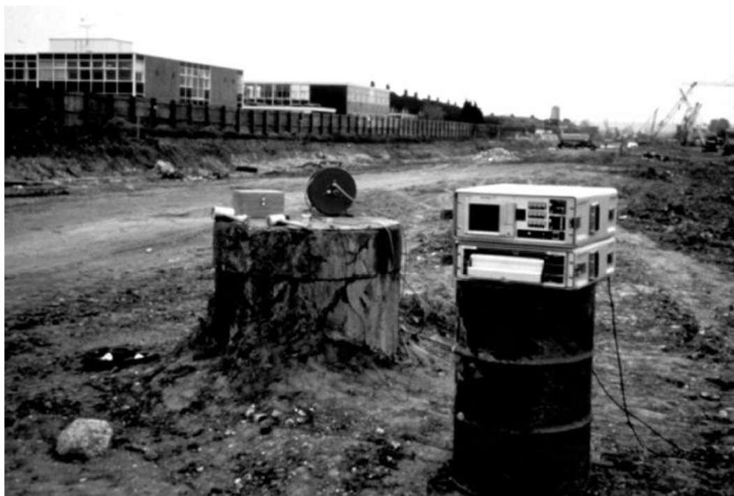
شکل ۳-۳ مجموعه تجهیزات MIMP در حال انجام آزمون روی یک شفت [۶]
