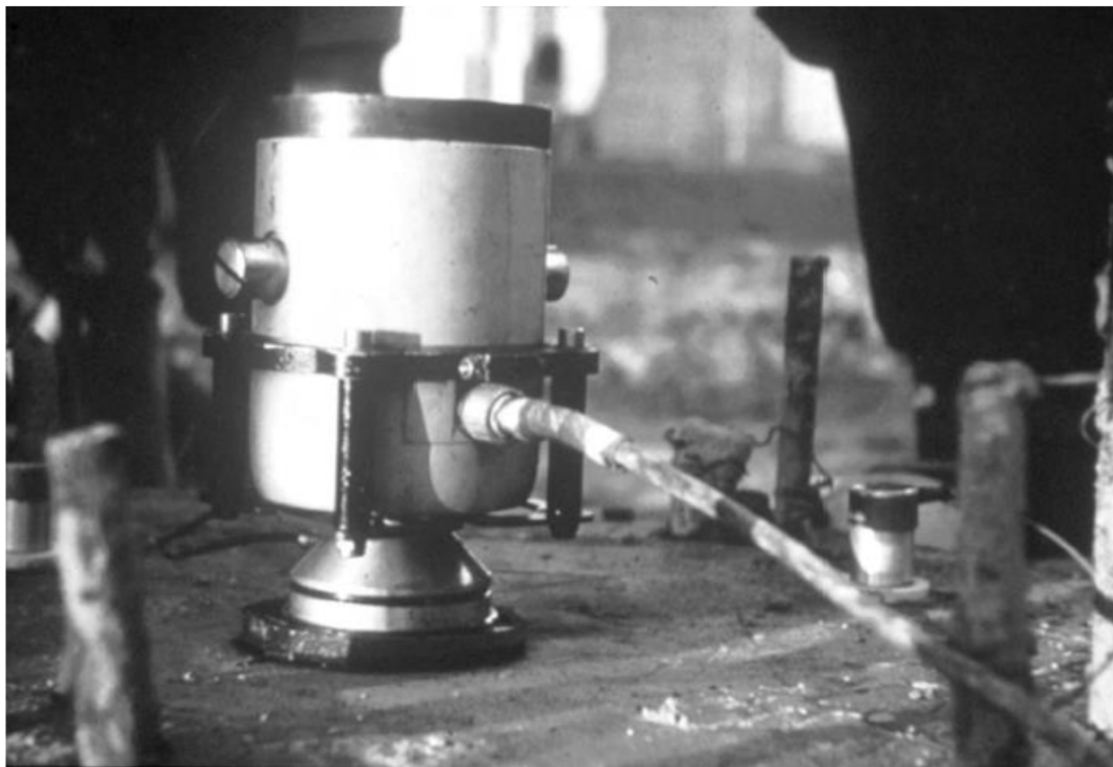
شکل ۳-۱ مجموعه تجهیزات انجام آزمون ارتعاش بر روی یک شفت حفاری شده [۶]
