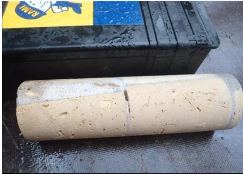
شکل ۵-۲۰: مغزه‌ی برداشت شده از قوس زیرین پل ۲۰۵۲۴
