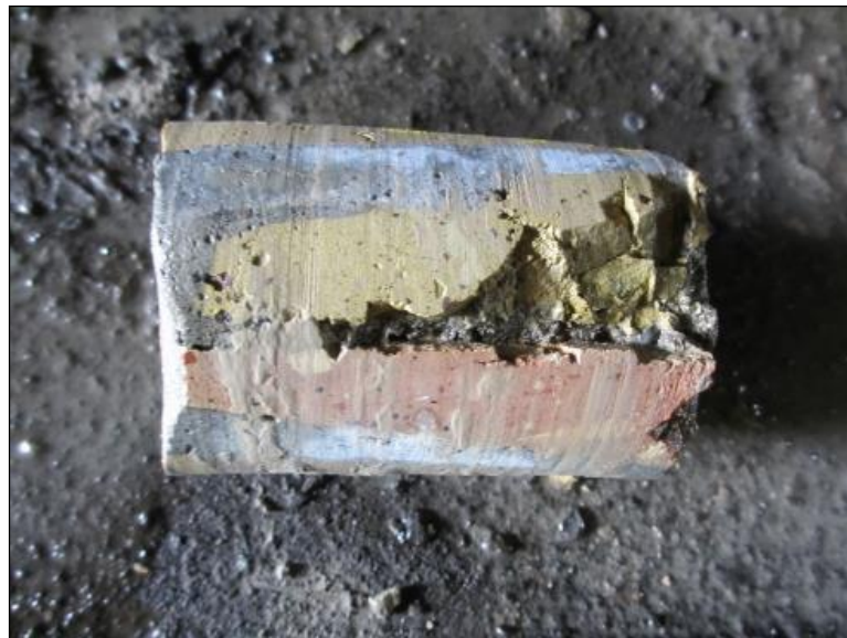
شکل ۵-۴۴: مغزه‌ای برداشت شده از قوس زیرین پل ۲۰۸۱۶
