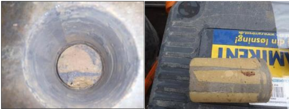
شکل ۵-۹: مغزه برداشته شده از قوس زیرین پل ۲۰۵۰۸
