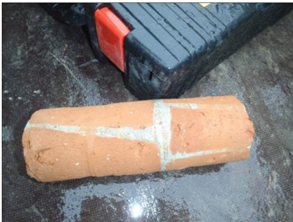
شکل ۵-۲۶: مغزه برداشت شده از قوس زیرین پل ۲۰۶۱۴
