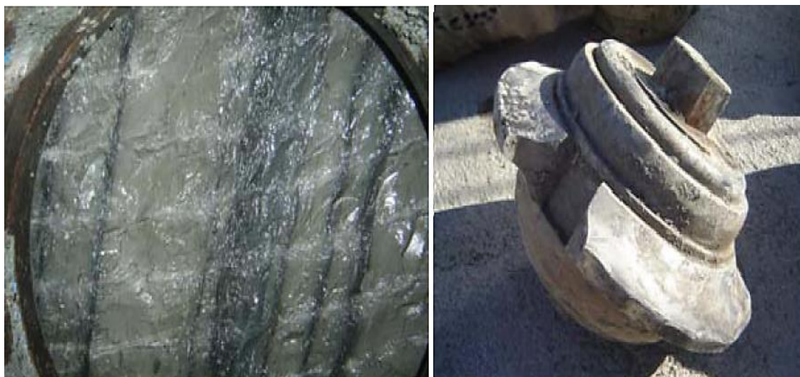
شکل (۷-۵) نمایی از یک تیغه‌ی شکسته‌شده و جبهه‌کار مختلط [۱۸۵]
