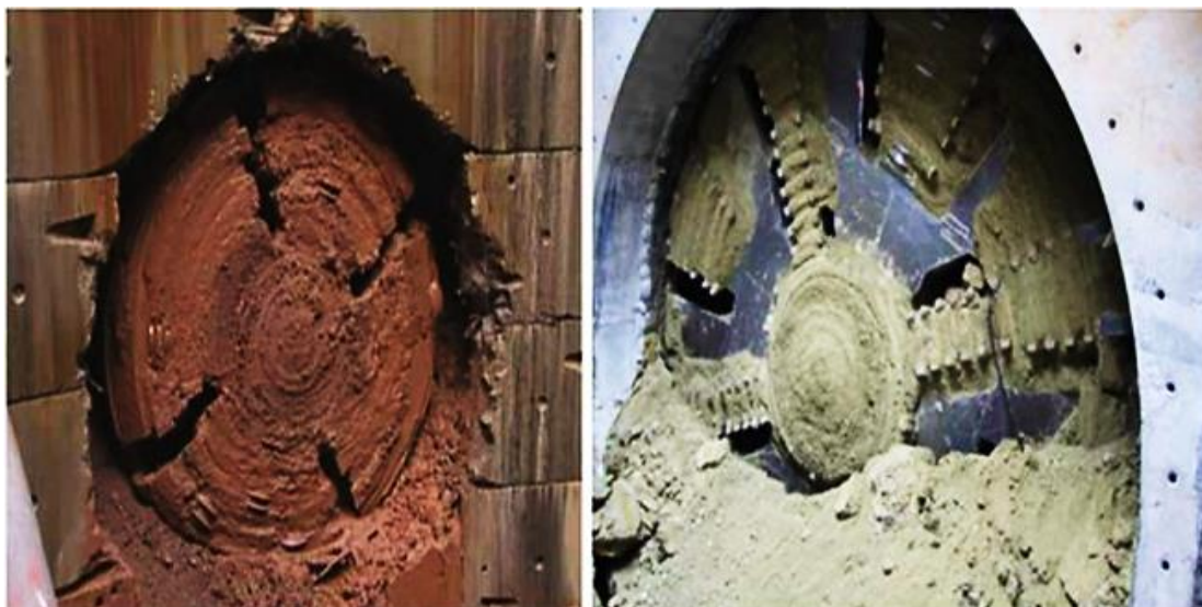
شکل (۵-۹) نمایی از گل گرفتگی کله‌ی حفاری [۲۰۵]
