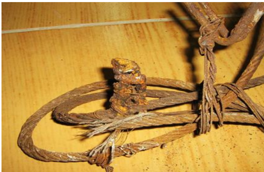
شکل (۱۳-۶) تأثیرات مخرب گاز سولفید هیدروژن بر سیم بکسل‌های نگهدارنده‌ی داکت هوا
