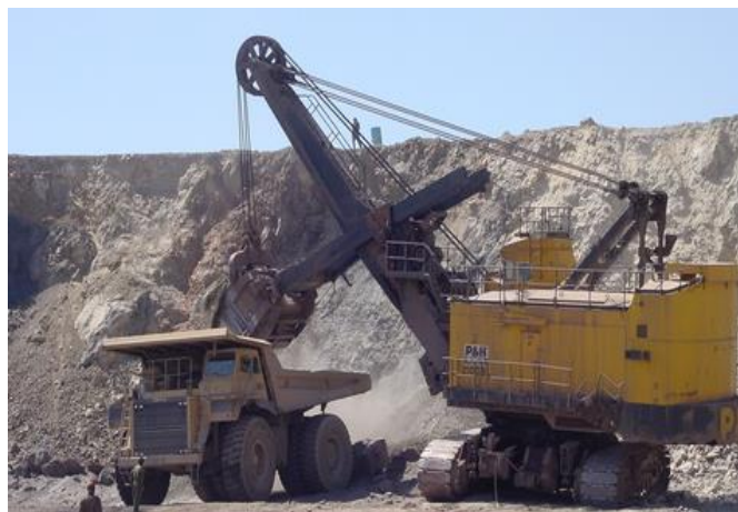
شکل ۳-۱- بارگیری و باربری توسط شاول و کامیون
