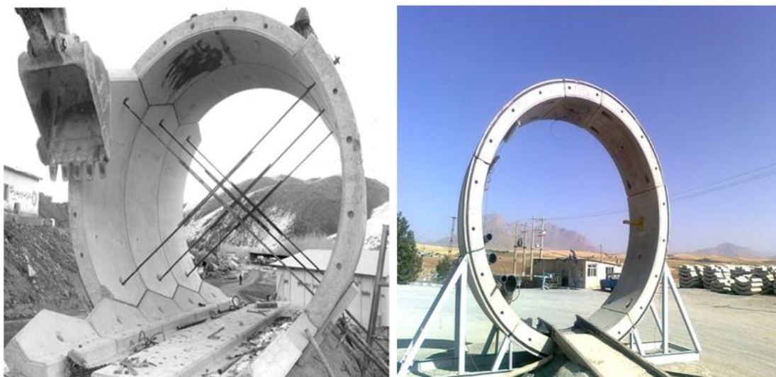
شکل ۲-۱۱- نمایش از حلقه آزمایشی قطعات (پروژه قمرود، ایران)
