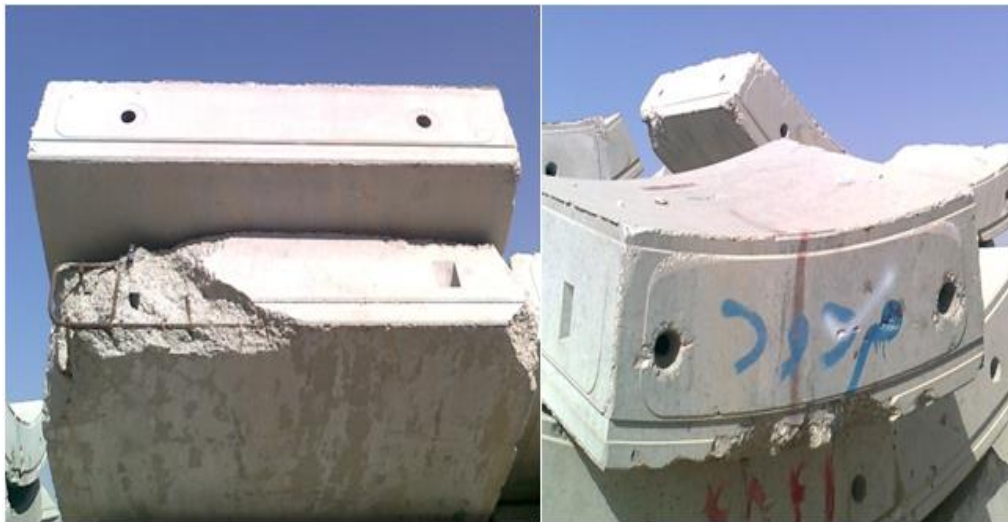
شکل ۲-۱۶- شکسته شدن گوشه‌های سگمنت (پروژه قمرود، ایران)
