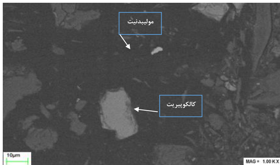
شکل (۴-۱۱): تصویر SEM از باطله نهایی کارخانه
