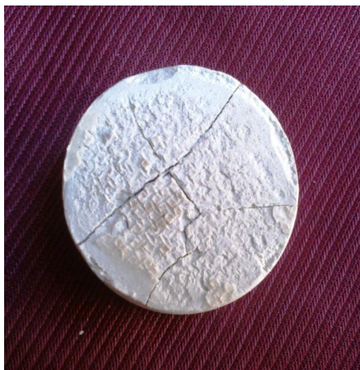
شکل ۴-۱۰ قرص مربوط به محفظه سیال حفاری پایه-آبی گلیکول
