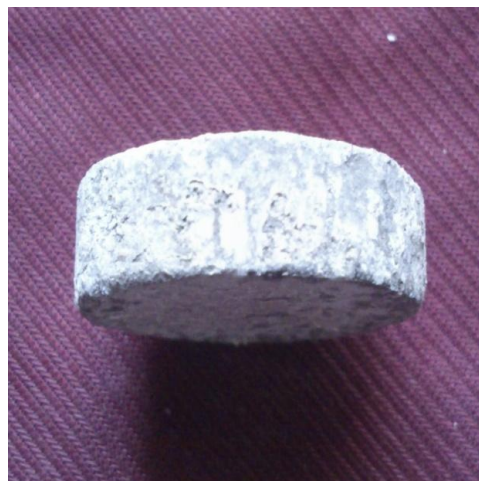
شکل ۴-۹ قرص مربوط به محفظه حاوی سیال پایه روغنی
