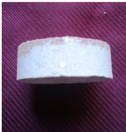
شکل ۴-۱۰ قرص مربوط به محفظه سیال حفاری پایه-آبی گلیکول
