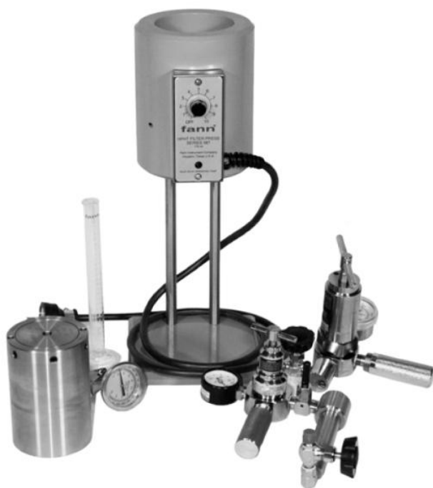
شکل ۲-۲۶ دستگاه اندازه‌گیری افت صافاب فشار بالا و دما بالا
