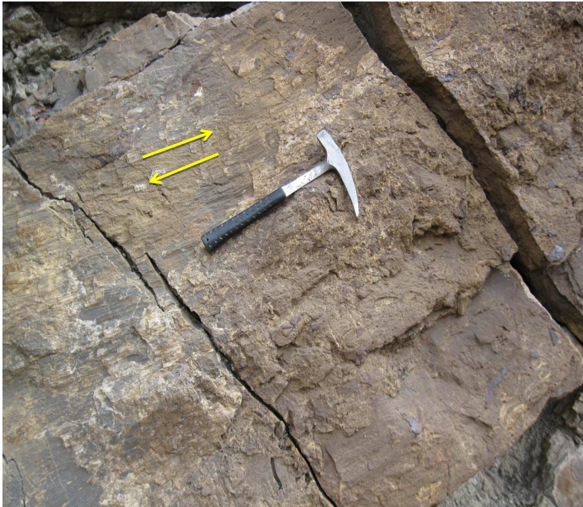
شکل (۵-۱۶): آینه گسل که خش لغزهای روی آن جهت غالب فعالیت گسل را نشان می‌دهد.
