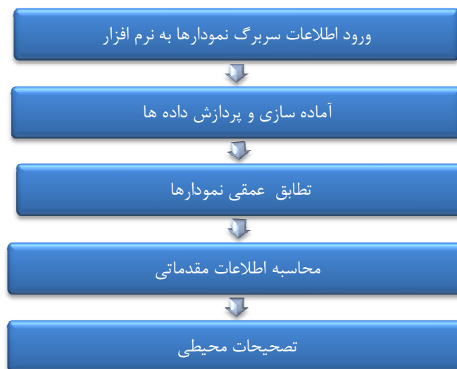
شکل (۳-۲) مراحل تهیه بانک اطلاعات پتروفیزیکی بوسیله نرم افزار IP
