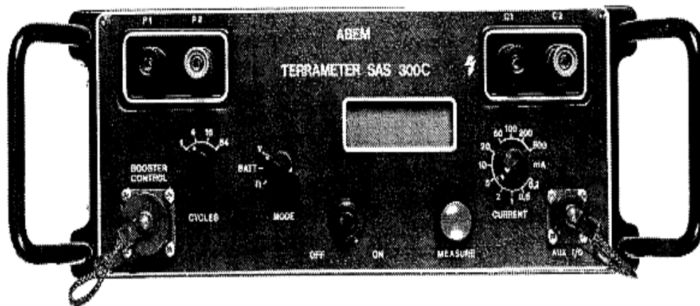
شکل (۶-۶): دستگاه SAS 300 ، ساخت شرکت سوئدی ABEM [ABEM, Instruction manual].
