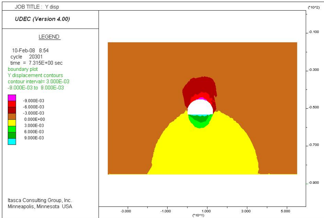
شکل ۶-۶۹- کنتور جابجایی قائم در زون Z13-2، دهانه خروجی تونل، پس از نصب شانکریت، پیچ سنگ و قاب
