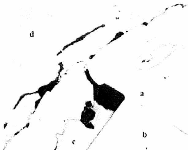
شکل ۲-۳- تصویر از مقطع G۱ (بزرگ‌نمایی ۲۰) a: دانه طلا در سطح کانی پیریت، b: کانی پیریت، c: کانی گالن، d: کانی کالکوپیریت
