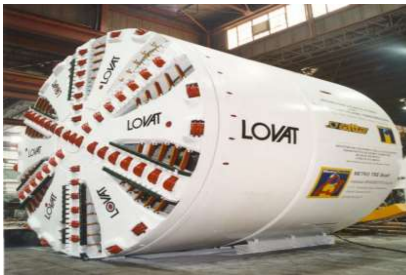
شکل ۲-۴ : نمایی از شیلد مورد استفاده در حفاری خط یک متروی تورین [۲۲]
