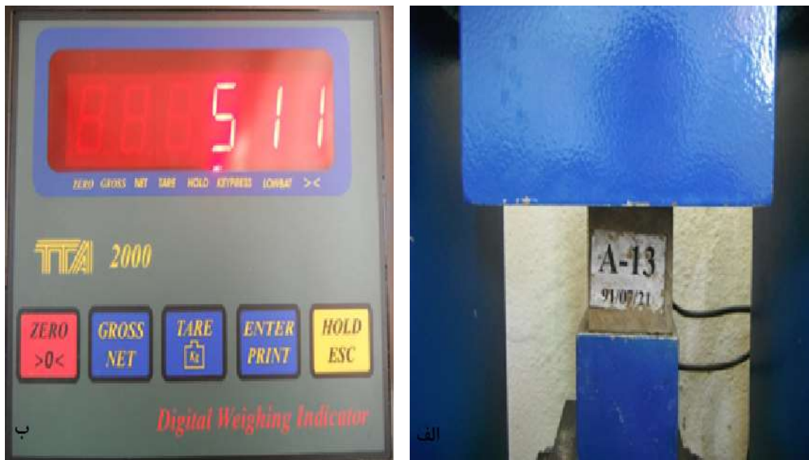
شکل ۵-۶: بارگذاری نمونه‌های دوغاب: الف) دستگاه بارگذاری استفاده شده، ب) نشان‌گر دیجیتالی دستگاه بارگذاری
