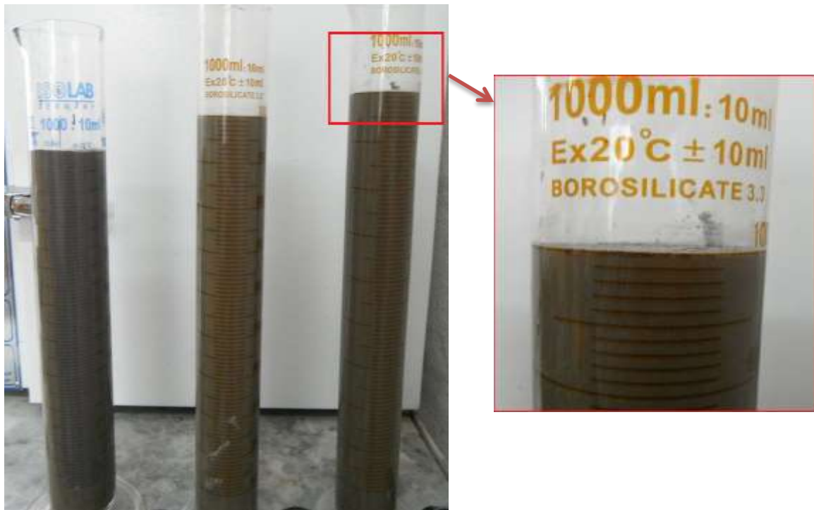
شکل ۵-۷: اندازه‌گیری مقدار آب‌اندازی
