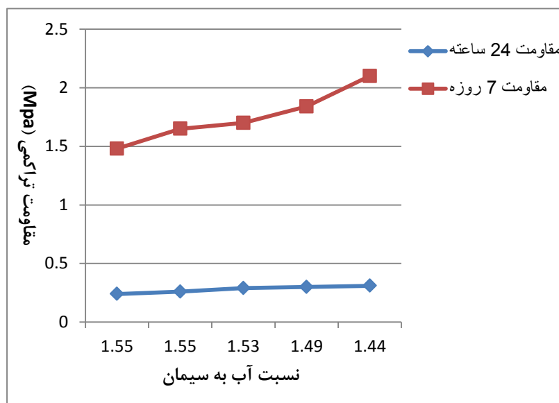
شکل ۵-۱۳: تأثیر نسبت آب به سیمان بر مقاومت تراکمی دوغاب
