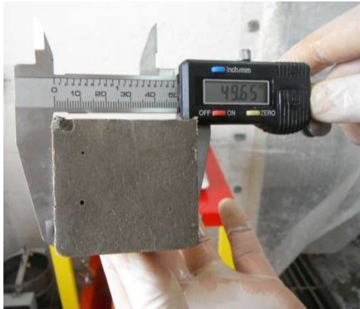
شکل ۵-۸ : اندازه‌گیری اُفت دوغاب
