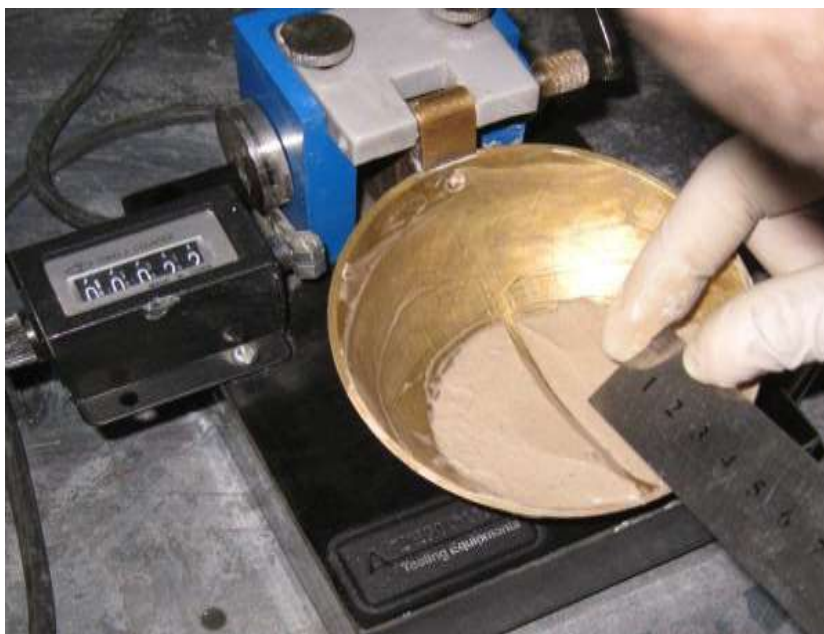
شکل ۵-۴ : آزمایش اندازه‌گیری حد روانی بنتونیت
