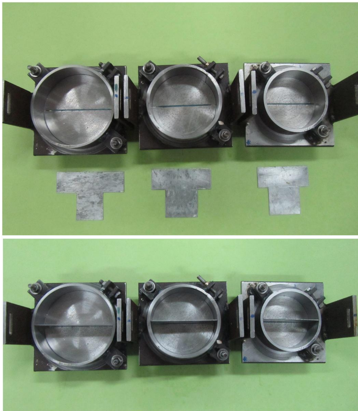
شکل ۴-۲۱- قالب‌های فلزی و تیغه‌های تقسیم‌کننده‌ی آن‌ها برای ساخت نمونه‌های نیم‌دیسکی سالم
