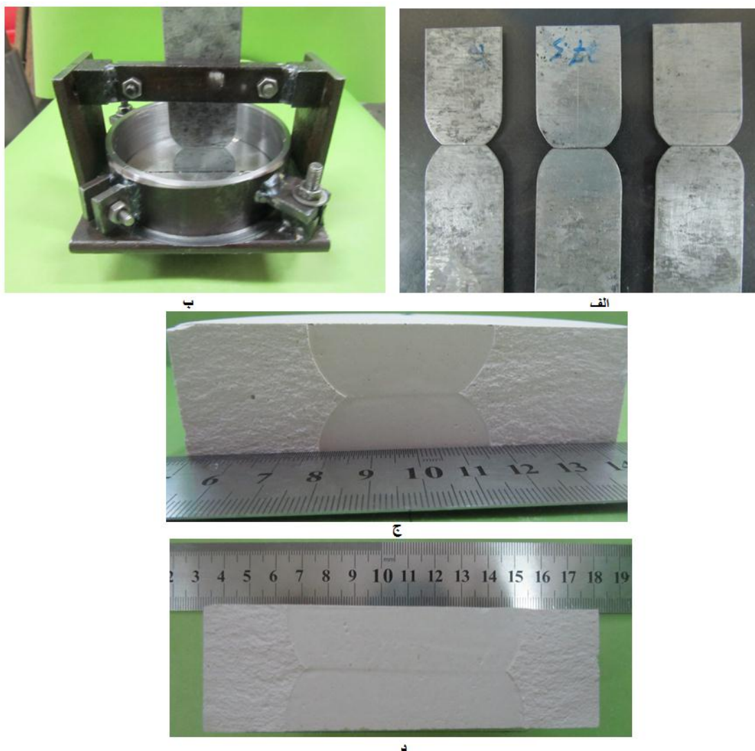
شکل ۴-۳۱- ساخت نمونه‌های دیسکی با ترک شورن مرکزی (الف) تیغه‌های دو تکه ب) نحوه‌ی قرارگیری تیغه‌ها در داخل قالب ج و د) نمایی از ترک‌های شورن ایجاد شده در نمونه‌ها
