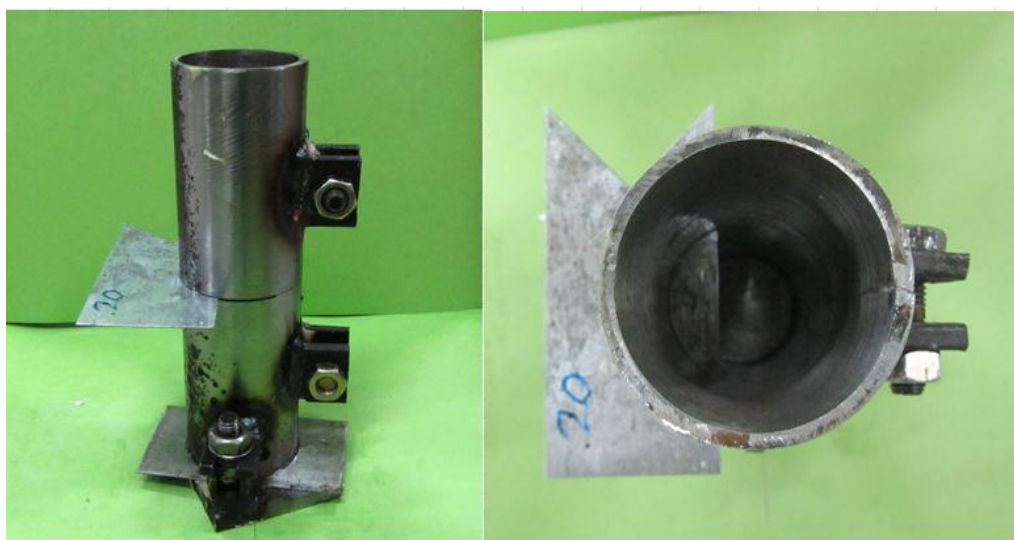
شکل ۴-۱۱- نمای جانبی و نما از بالای نحوه‌ی قرارگیری تیغه در قالب فلزی برای ایجاد شکاف مستقیم
