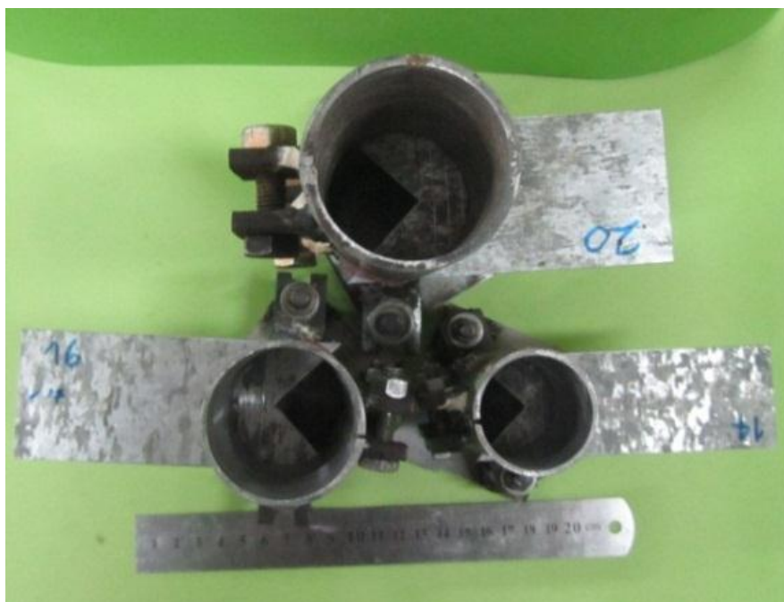
شکل ۴-۶- نمای از بالا از نحوه‌ی قرارگیری تیغه‌ها در قالب‌های فلزی برای ایجاد ترک شوره در نمونه‌های روش CB
