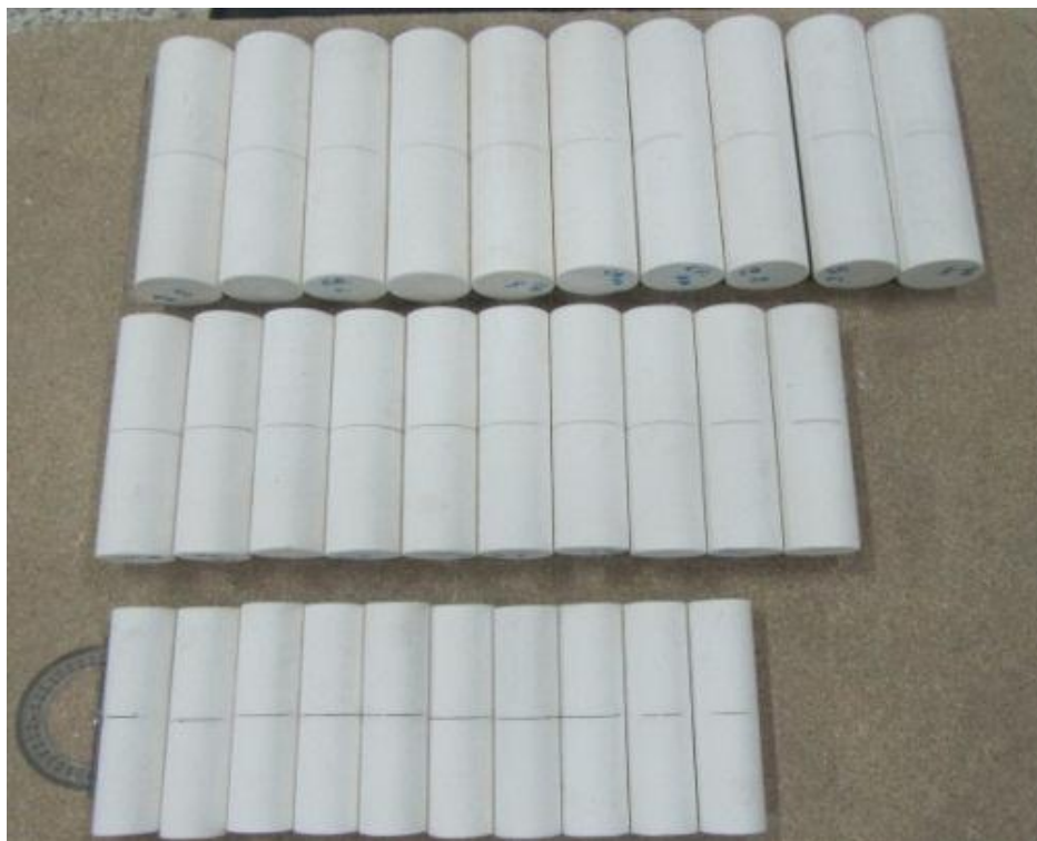
شکل ۴-۱۲- تعدادی از نمونه‌های ساخته شده برای روش SECRRBB
