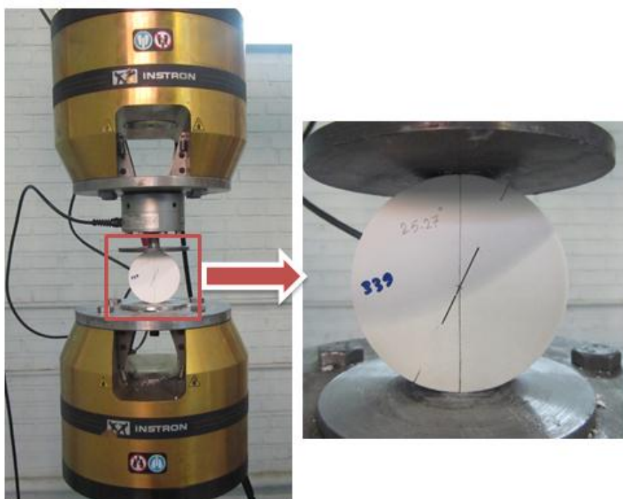
شکل ۴-۳۹- نحوه‌ی بارگذاری نمونه‌های روش CSTBD در حالت مود برشی خالص
