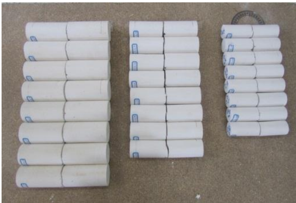
شکل ۴-۸- تعدادی از نمونه‌های روش CB پس از بارگذاری
