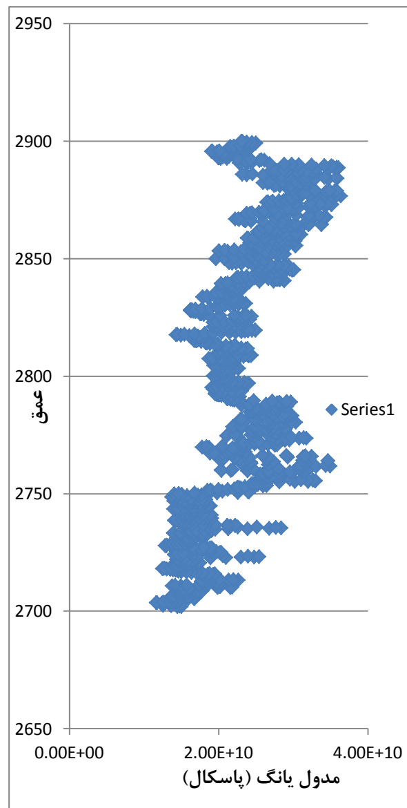
شکل ۴-۲۰: مدول یانگ بدست آمده از نگاره صوتی در چاه شماره ۵
