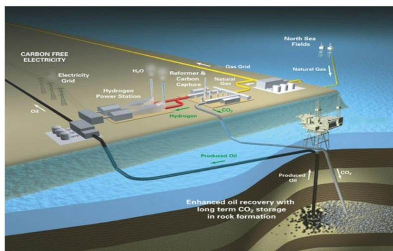
شکل ۳-۲: طرح شماتیک تزریق دی‌اکسیدکربن به میدان نفت و گاز (Lund, 2009)
