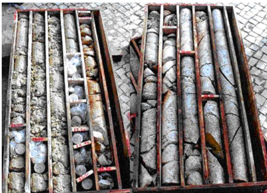
شکل (۲-۳) نمونه‌ای از مغزه‌های گرفته شده از محیط دارای شرایط جبهه‌کار مختلط [۴۵]
