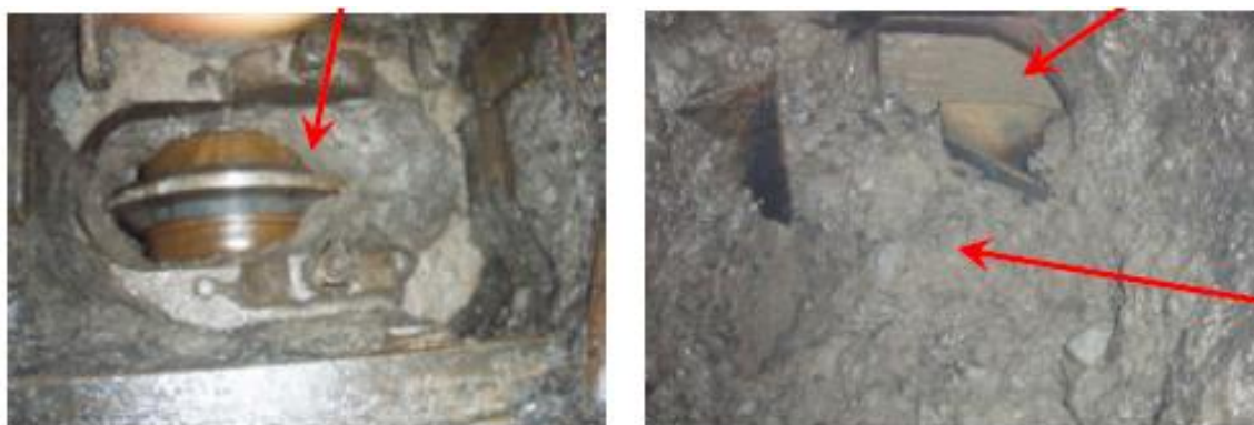
شکل (۳-۶) گل گرفتگی دهانه اسکریپر (راست) و دیسک (چپ) (دید از داخل کله حفار) [۶۴]
