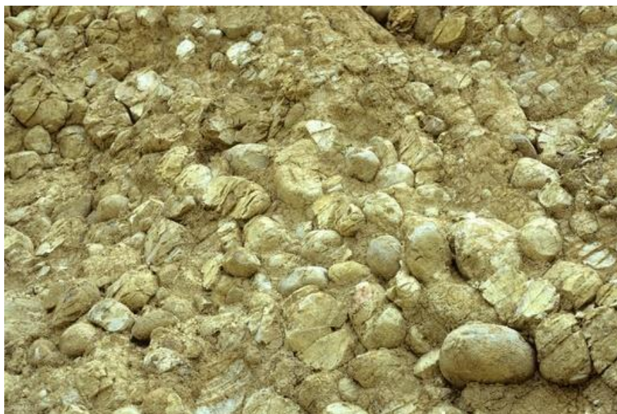
شکل (۳-۱): جبهه کار مختلط (وجود قلوه سنگ در ماتریس خاک) [۴۵]
