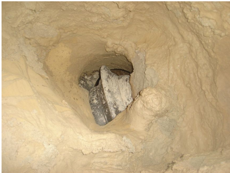
شکل ۴-۸- گل گرفتگی دیسک کاتر (تونل کرج ۱)
