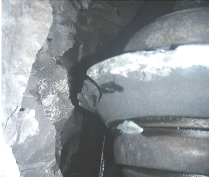
شکل ۴-۴ - شکستگی دیسک کاتر به دلیل درزه و شکاف توده‌سنگ (تونل نوسود ۲)
