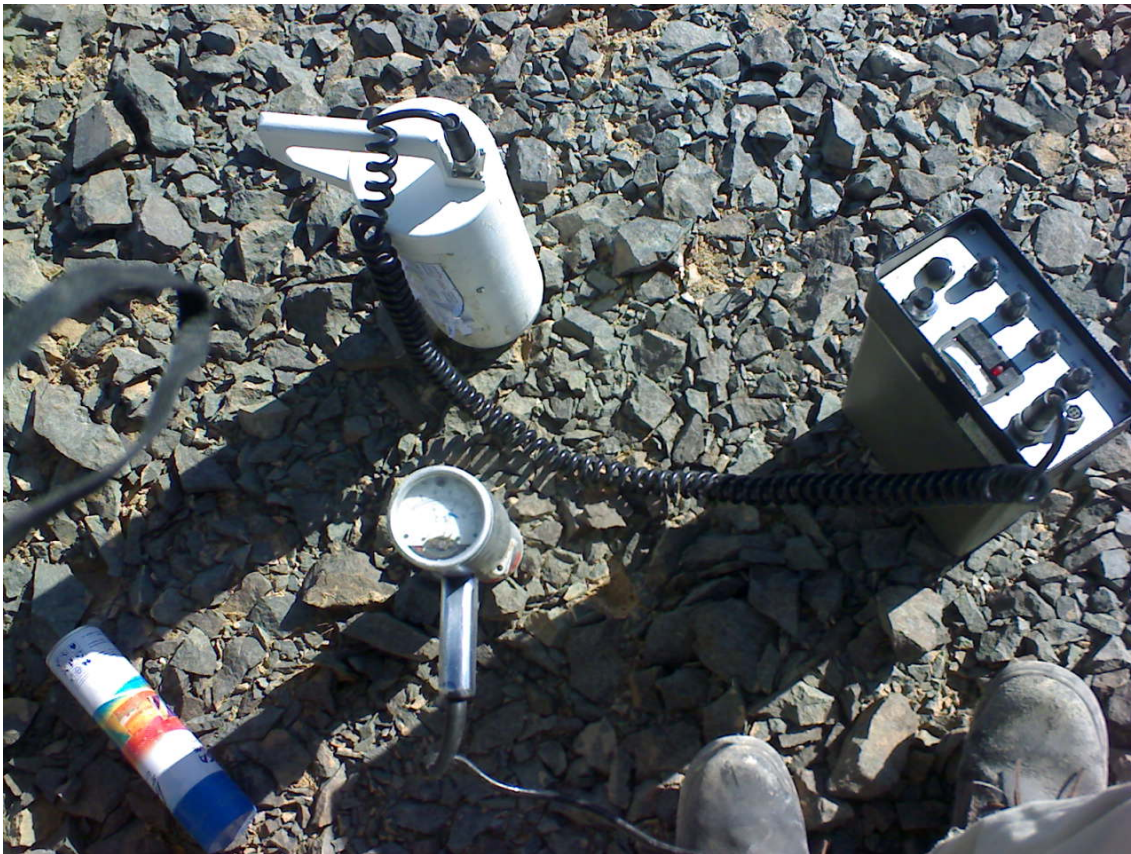
شکل (۵-۳): دستگاه اسپکترومتر GR-410 در کنار دستگاه سینتیلومتر SPP2
