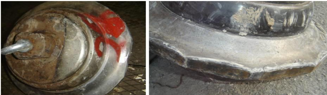
شکل ۴-۵: نمونه‌ای از ساییدگی نامتقارن تیغه‌های برشی [۳۹]
