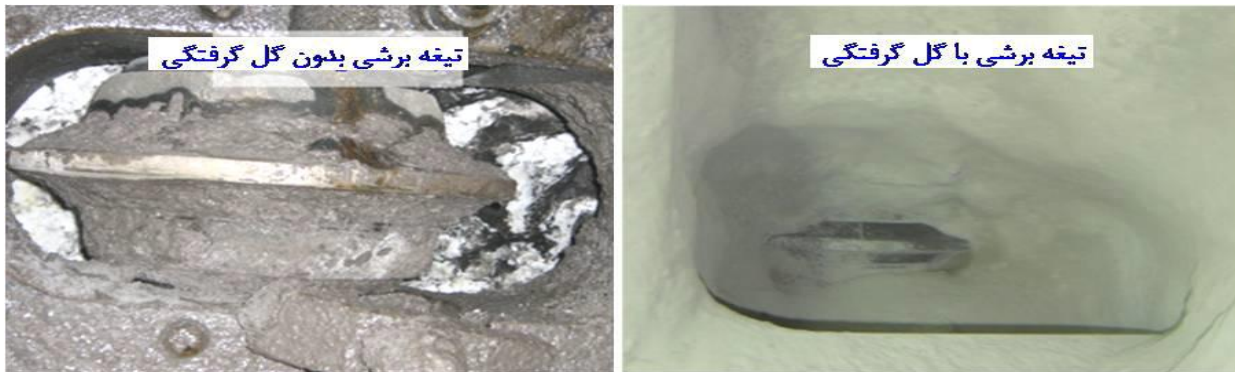
شکل ۴-۴: وضعیت تیغه‌های برشی در حالت گل گرفتگی و بدون گل گرفتگی [۳۹]
