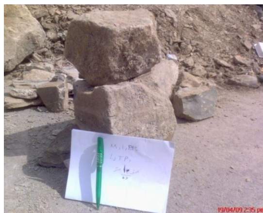
شکل ۳-۴: نمونه‌ای از بولدرها در حفاری چاهک L2TP1 [۳۸]
