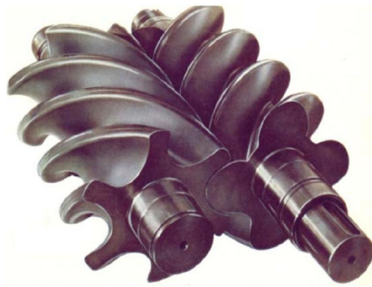
شکل ۴-۴- کمپرسور اسکرو در ماشین های حفاری معدن مس سرچشمه
