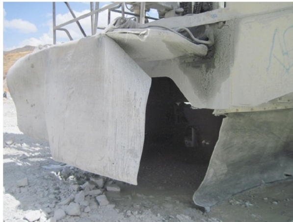
شکل ۳-۸- کنترل مرطوب گرد و غبار
