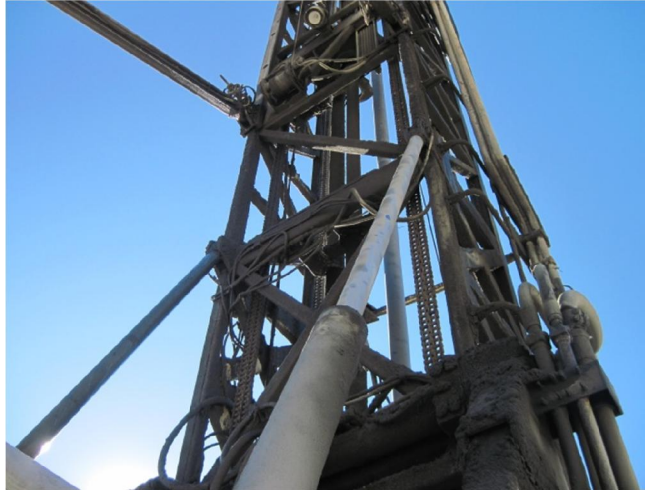
شکل ۳-۱۰- سیلندرهای بالابر دکل
