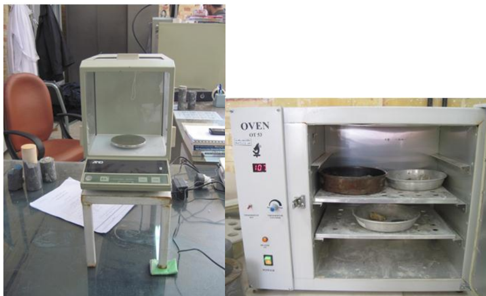
الف- دستگاه خشک‌کن جهت خشک کردن نمونه‌ها ب- دستگاه توزین نمونه‌ها
