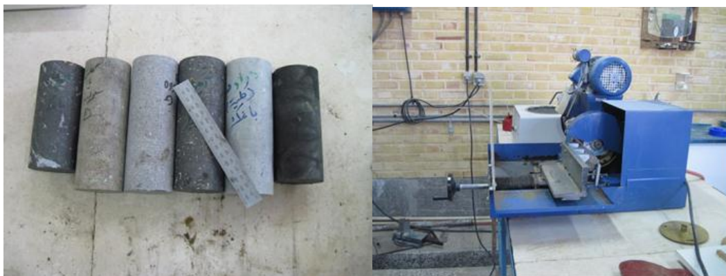
الف- دستگاه برش جهت برش و آماده سازی نمونه ها ب- نمونه های برش داده شده جهت عملیات بارگذاری شکل ۵-۷- آماده سازی نمونه ها جهت عملیات بارگذاری
