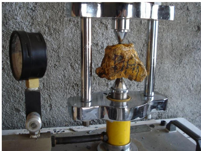
شکل ۵-۳۴- آزمایش مقاومت بار نقطه‌ای نمونه شماره ۱ سنگ هماتیت معدن دردوی
