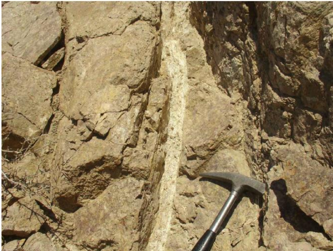
شکل ۴۱-۵- پرشدگی گرانیت توسط کلسیت در معدن دردوی
