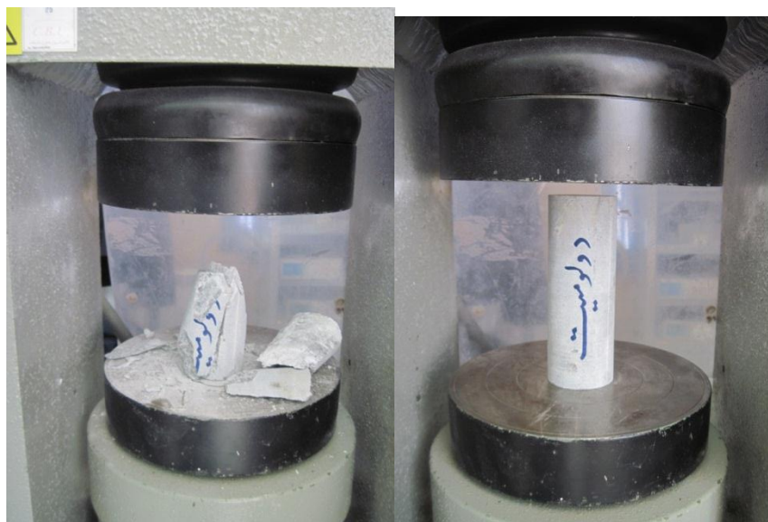
الف- نمونه دولومیت قبل از عملیات بارگذاری ب- نمونه دولومیت بعد از عملیات بارگذاری شکل ۵-۸- بارگذاری فشاری نمونه دولومیت
