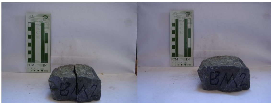
الف- نمونه مگنتیت قبل از عملیات بارگذاری ب- نمونه مگنتیت بعد از عملیات بارگذاری
