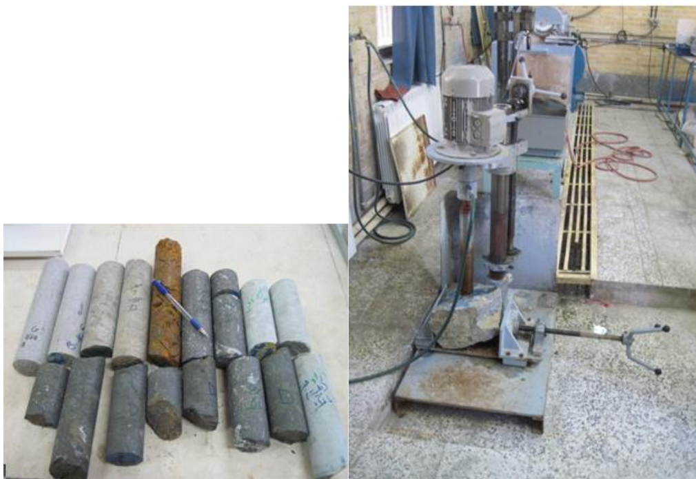
ب- نمونه های استوانه ای تهیه شده قبل از برش
