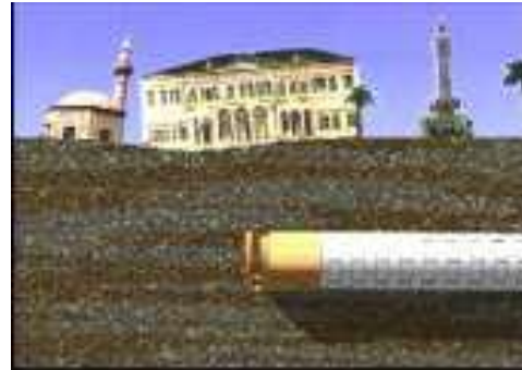
شکل ۶-۱: نشست حاصل از حفار مکانیزه شهری
