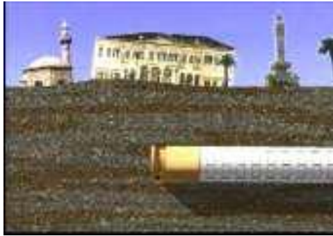
شکل ۶-۲: بالا زدگی حاصل از حفار مکانیزه شهری
