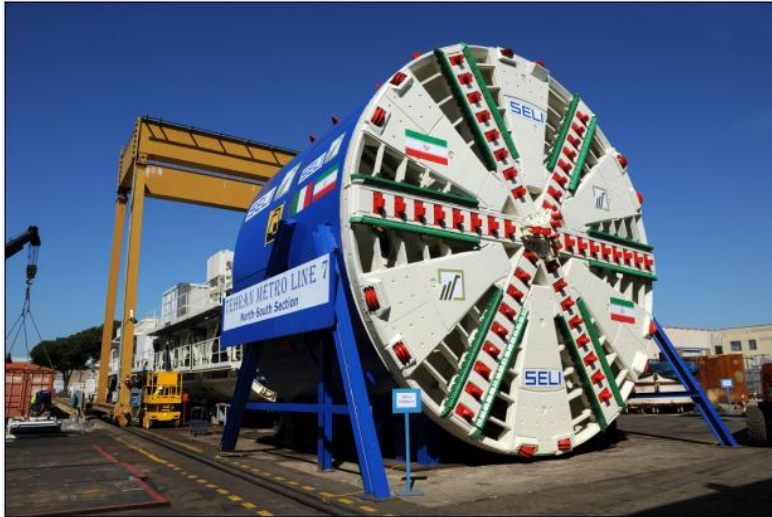
شکل ۴-۱: ماشین حفاری فشار تعادلی زمین قطعه شرقی غربی تونل خط هفت متروی تهران [۲]
