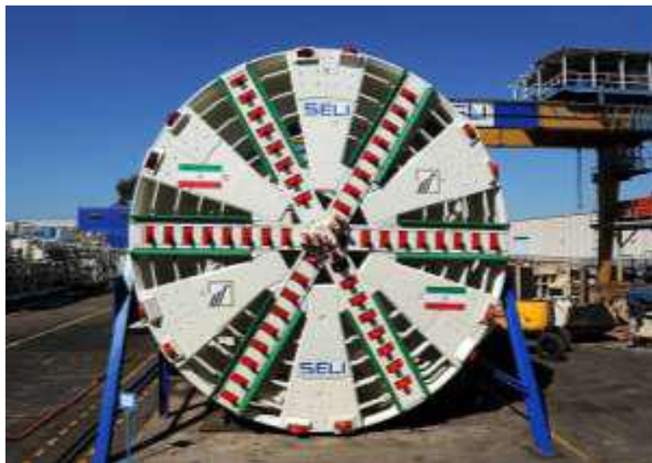
شکل ۲-۵: سپر متعادل کننده فشار زمین پروژه خط ۷ مترو تهران [۲]
