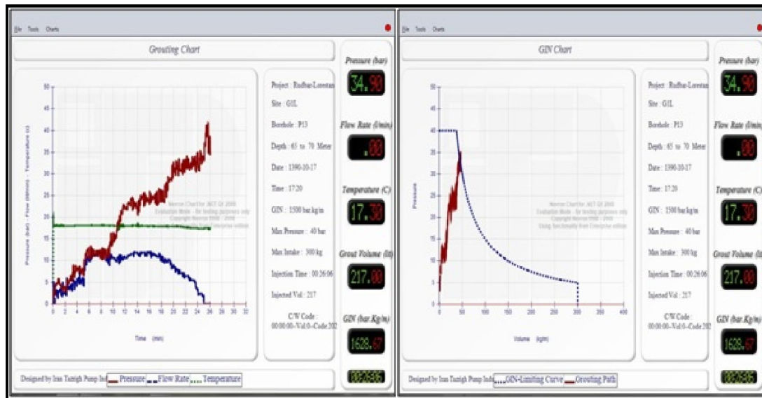
شکل ۴-۲۳- منحنی عدد G.I.N و مسیر تزریق مربوط به گمانه G1LP13
