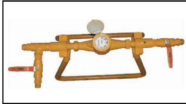
شکل ۴-۱۴- دستگاه آزمایش فشار آب لوژان استفاده شده در طرح
