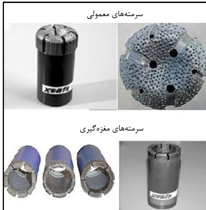
شکل ۴-۶- سرمته‌های مغزه‌گیری و معمولی استفاده شده در طرح رودبار لرستان
