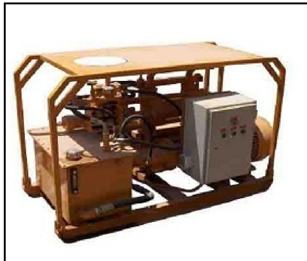
شکل ۴-۷- پمپ تزریق مدل P-۱۸۰ شرکت ITP، استفاده شده در طرح
