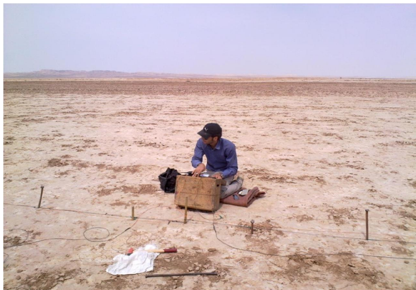
شکل ۲-۳- دستگاه‌های اندازه‌گیری اختلاف پتانسیل [سازمان آب منطقه‌ای سمنان، ۱۳۹۰]
