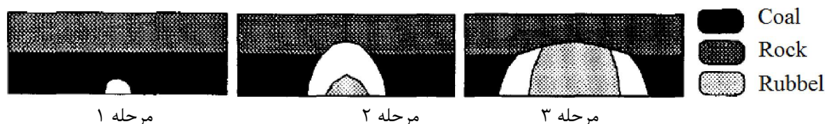
شکل ۴-۵: مراحل گسترش راکتور UCG (Kuyper, 1994).
